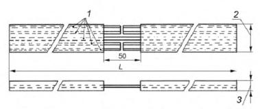
† — корды; 2 — ширина образца: 3 — толщина образца; L — длина образца
