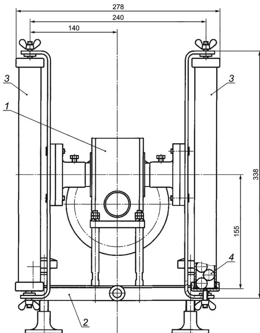
1 — мотор-редуктор; 2 — плита; 3 — цилиндры; 4 — стальные шары
