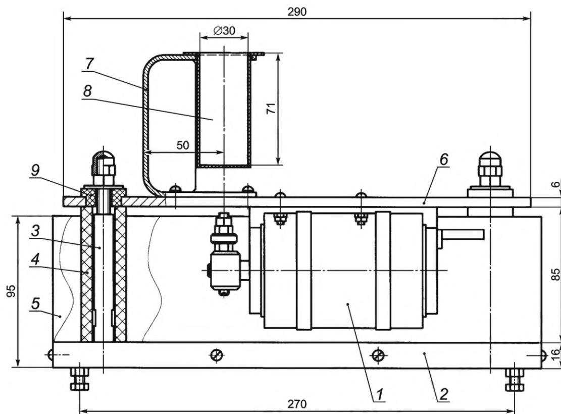
1 — мотор-вибратор; 2 — опорная плита; 3 — стойка; 4 — резиновая втулка; 5 — кожух; 6 — верхняя плита; 7 — кронштейн;
