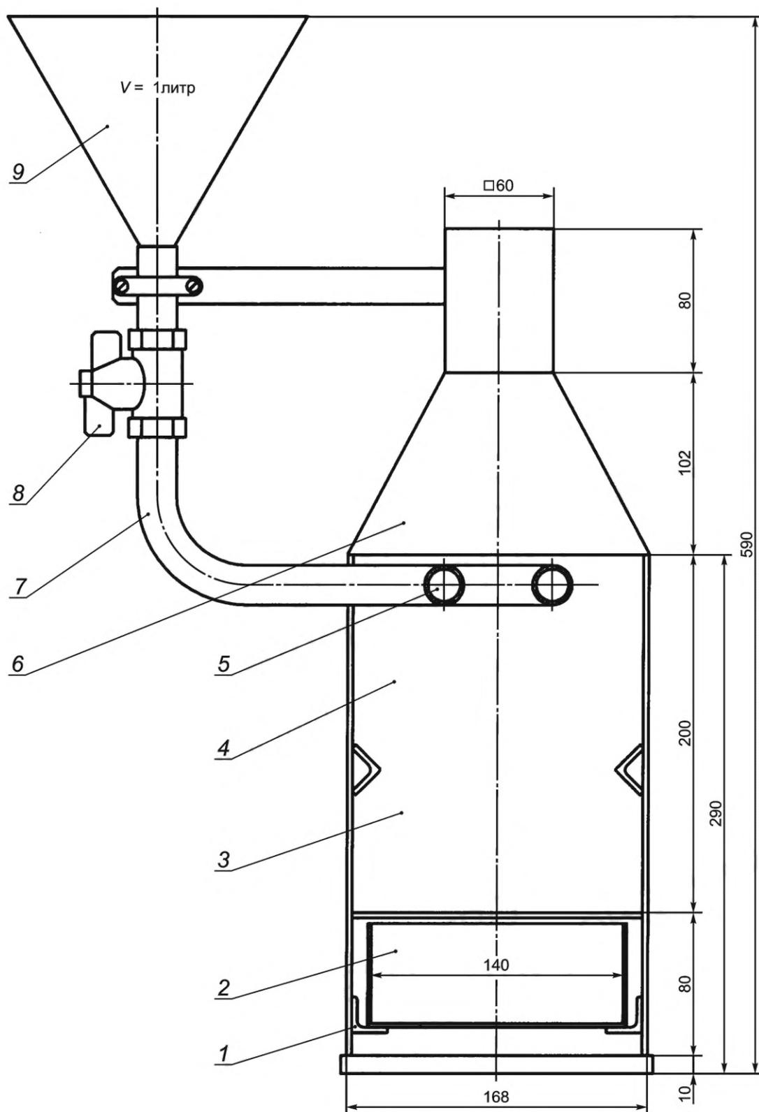
1 — направляющая; 2 — ящик для кокса; 3 — реторта для коксования; 4 — камера; 5 — разбрызгиватель; 6 — отвод паров;
