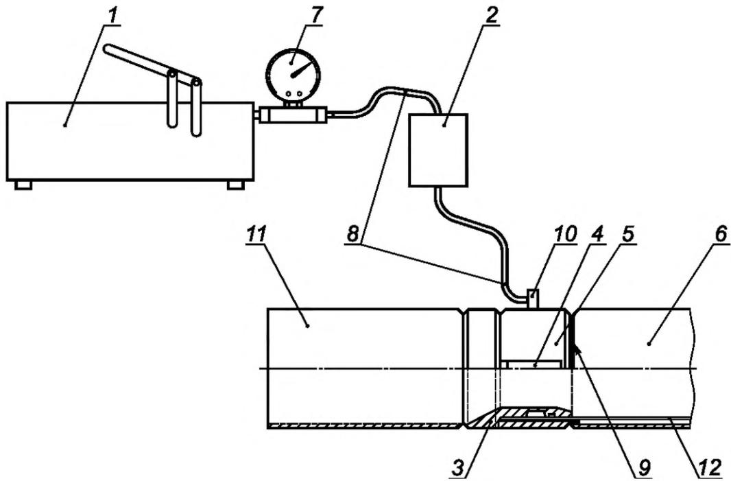
1 — гидравлический насос; 2 — пресс-цилиндр; 3 — сердечник соединителя; 4 — продольные полоски гибкого рукава; 5 — наружная втулка соединителя; 6 — футляр; 7 — манометр; 8 — высоконапорные шланги; 9 — сварной шов; 10 — ниппель наружной втулки; 11 — привариваемый конец внутренней втулки; 12 — гибкий рукав
