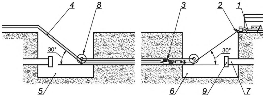
1 — лебедка; 2 — устройство дополнительного фиксирования лебедки; 3 — буксировочная головка; 4 — профилированный гибкий рукав; 5 — стартовый котлован; 6 — приемный котлован; 7 — подземный трубопровод; 8 — опорные ролики; 9 — заглушки
