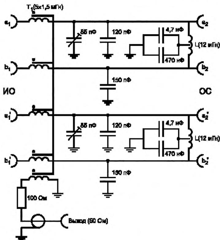
Рисунок В.3 — Эквивалент полного сопротивления сети для применения с двумя незэкранированными симметричными парами (вариант 1)
