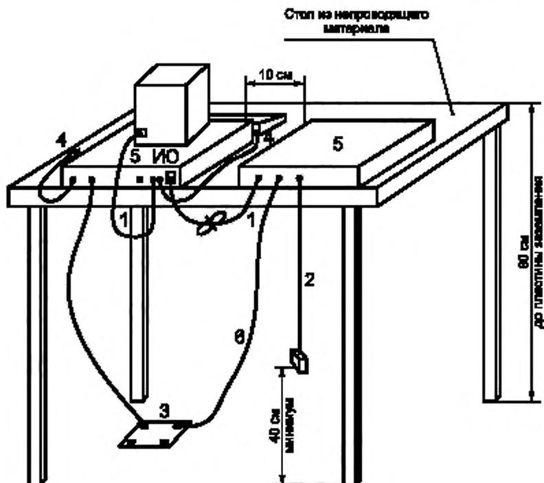
1 — кабели, которые висят на расстоянии менее 40 см от горизонтальной пластины заземления и не могут быть укорочены до подходящей длины, укладывают в связки длиной от 30 до 40 см;
