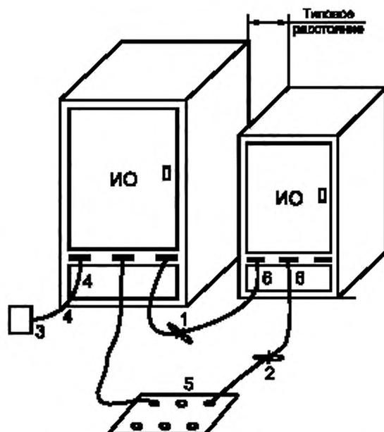
1 — кабели, которые висят на расстоянии менее 40 см от горизонтальной пластины заземления и не могут быть укорочены до подходящей длины, укладывают в связки длиной от 30 до 40 см;
