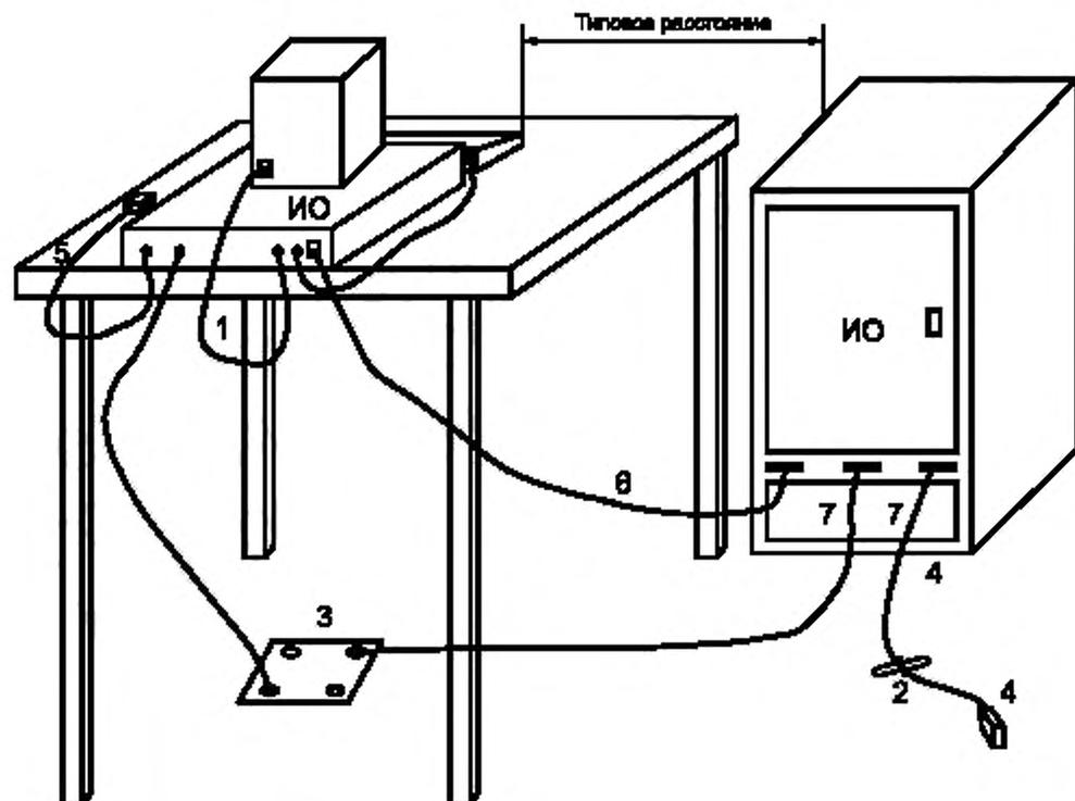
1 – кабели, которые висят на расстоянии менее 40 см от горизонтальной пластины заземления и не могут быть укорочены до подходящей длины, укладывают в связки длиной от 30 до 40 см;
