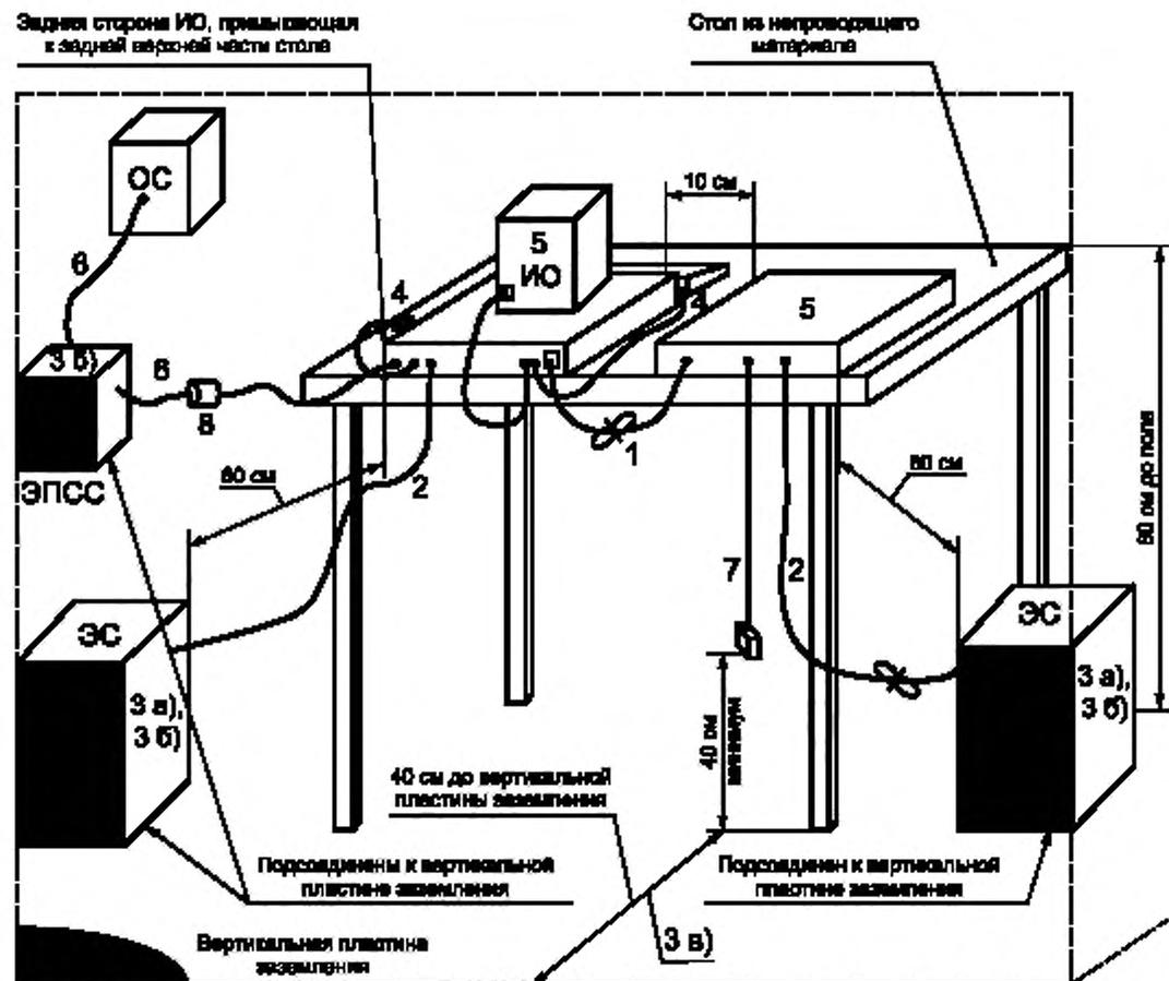
1 — кабели, которые висят на расстоянии менее 40 см от горизонтальной пластины заземления и не могут быть укорочены до подходящей длины, укладывают в связки длиной от 30 до 40 см;
