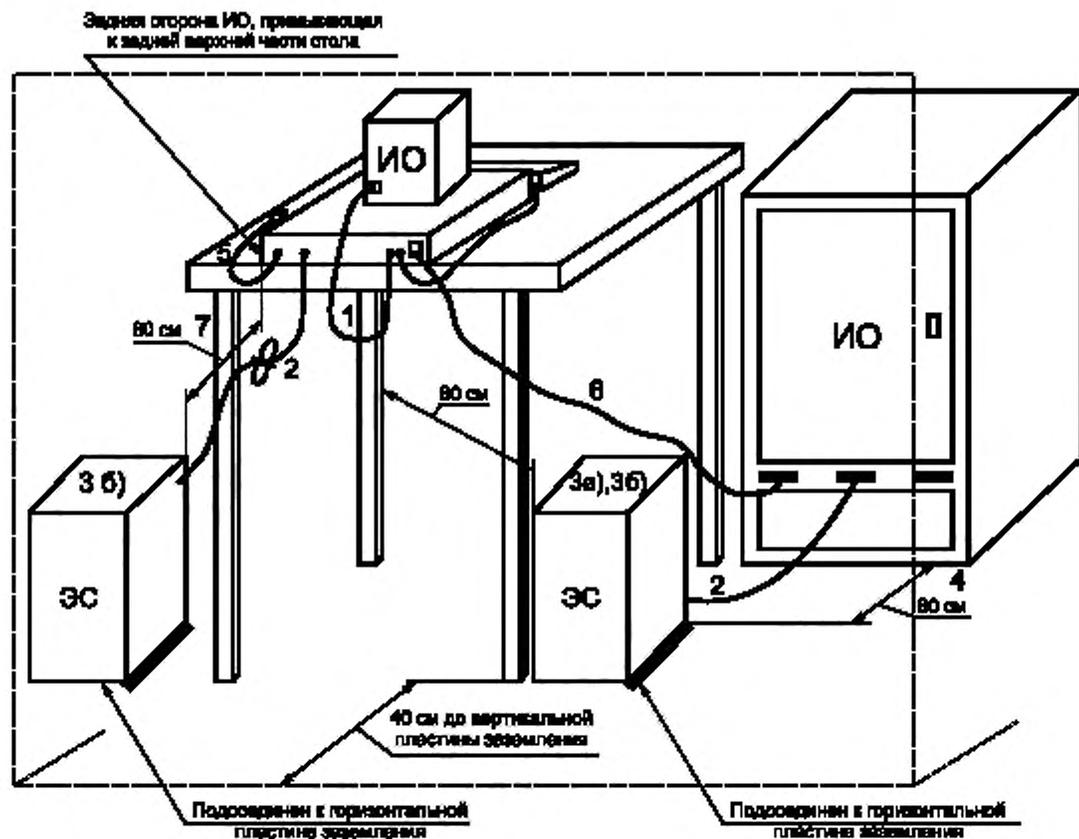
1 — кабели, которые висят на расстоянии менее 40 см от горизонтальной пластины заземления и не могут быть укорочены до подходящей длины, укладывают в связку длиной от 30 до 40 см;
