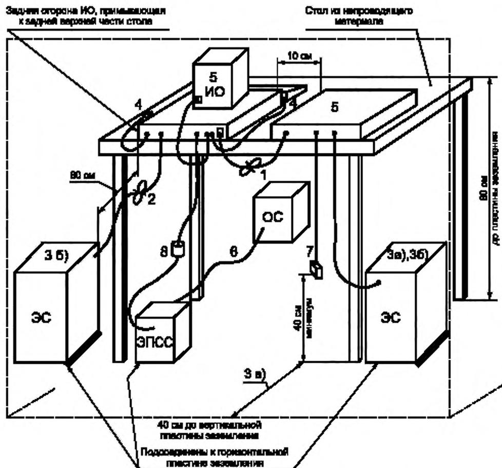
ЭС — V-образный эквивалент сети; ИО — испытуемое оборудование; ОС — оборудование, связанное с ИО; ЭПСС — эквивалент полного сопротивления сети;
