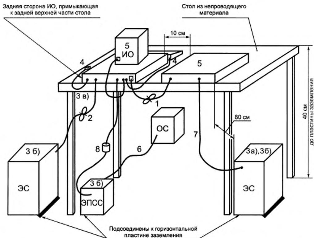
1 — кабели, которые висят на расстоянии менее 40 см от горизонтальной пластины заземления и не могут быть укорочены до подходящей длины, укладывают в связки длиной от 30 до 40 см;
