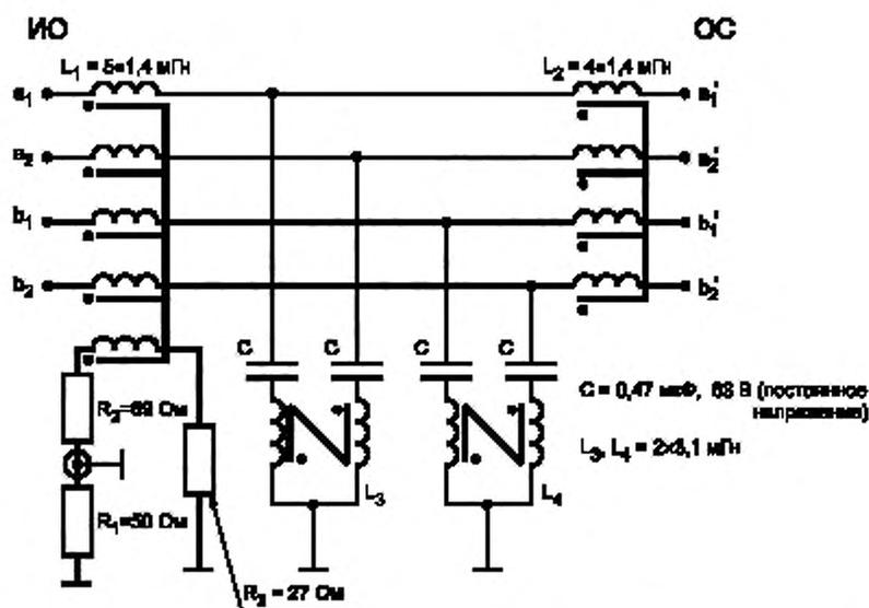
Рисунок В.2 — Эквивалент полного сопротивления сети с большим затуханием продольного перехода для применения с двумя незэкранированными симметричными парами
