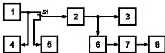
1 — генератор сигналов НЧ; 2 — передатчик; 3 — эквивалент антенны; 4 — милливольтметр НЧ; 5 — измерительный экранированный резистор сопротивлением (600±30) Ом; 6 — элемент связи; 7 — девиометр; 8 — псофометр или милливольтметр НЧ; S1 — переключатель
