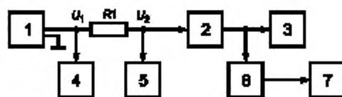
1 — генератор сигналов НЧ; 2 — передатчик; 3 — эквивалент антенны; 4, 5 — милливольтметры НЧ; 6 — элемент связи; 7 — девиометр;  $R1$  — резистор сопротивлением  $(2 \pm 0,1)$  кОм
