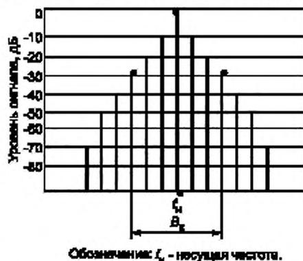
Рисунок 21 — Отчет контрольной ширины полосы частот  $B_k$  на экране анализатора спектра с логарифмическим детектором
