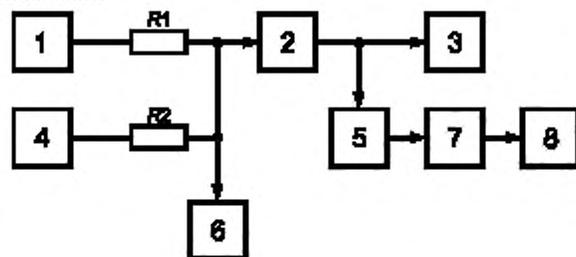
1 — генератор сигналов НЧ; 2 — передатчик; 3 — эквивалент антенны; 4 — генератор сигналов НЧ; 5 — элемент связи; 6 — милливольтметр НЧ; 7 — девиометр; 8 — анализатор спектра НЧ; R1, R2 — резисторы сопротивлением (5,1±0,25) кОм
