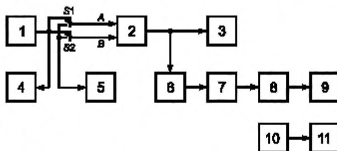
1 — генератор сигналов НЧ; 2 — передатчик; 3 — эквивалент антенны; 4 — милливольтметр НЧ; 5 — измерительный экранированный резистор сопротивлением (600±30) Ом; 6 — элемент связи; 7 — девиометр; 8 — декодер стереосигнала; 9 — анализатор спектра НЧ; 10 — корректирующий фильтр; 11 — осциллограф; S1, S2 — переключатели
