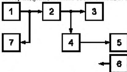
1 — генератор сигналов НЧ; 2 — передатчик; 3 — эквивалент антенны; 4 — элемент связи; 5 — модулометр; 6 — девиометр; 7 — милливольтметр НЧ
