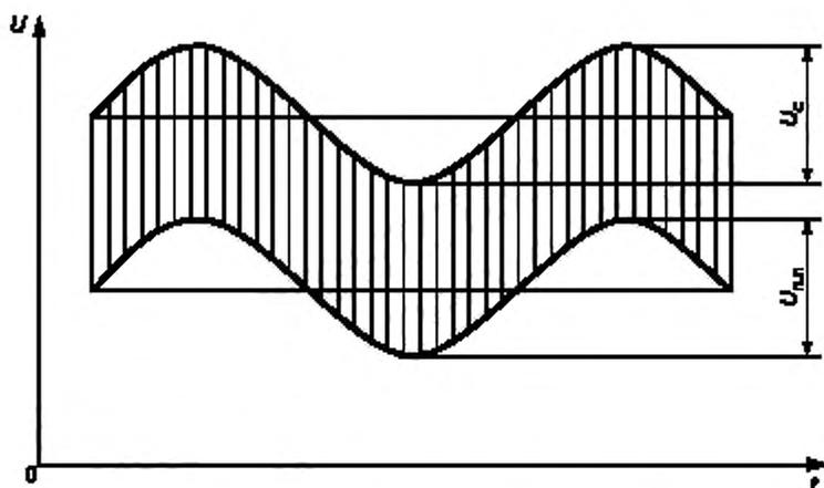
Рисунок 166 — Осциллограмма корректированного КСС с переходной помехой на модулирующих частотах 100 Гц и менее
