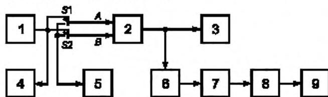
1 — генератор сигналов НЧ; 2 — передатчик; 3 — эквивалент антенны; 4 — милливольтметр НЧ; 5 — измерительный экранированный резистор сопротивлением (600±30) Ом; 6 — элемент связи; 7 — девиометр; 8 — декодер стереосигнала; 9 — ИНИ или анализатор спектра НЧ; S1, S2 — переключатели
