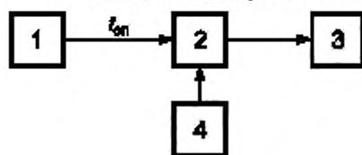
1 — возбудитель передатчика; 2 — частотный компаратор; 3 — частотомер; 4 — стандарт частоты;  $f_{\text{оп}}$  — опорная частота
