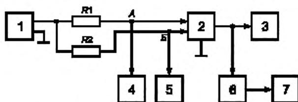
1 — генератор сигналов НЧ; 2 — передатчик; 3 — эквивалент антенны; 4, 5 — милливольтметры НЧ; 6 — элемент связи; 7 — девиометр;  $R1, R2$  — резисторы сопротивлением  $(300 \pm 0,3)$  Ом
