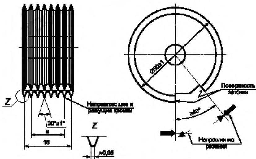
Направляющие кромки должны быть одного и того же диаметра. Если износ режущих кромок превышает 0,1 мм, необходима их заточка.
