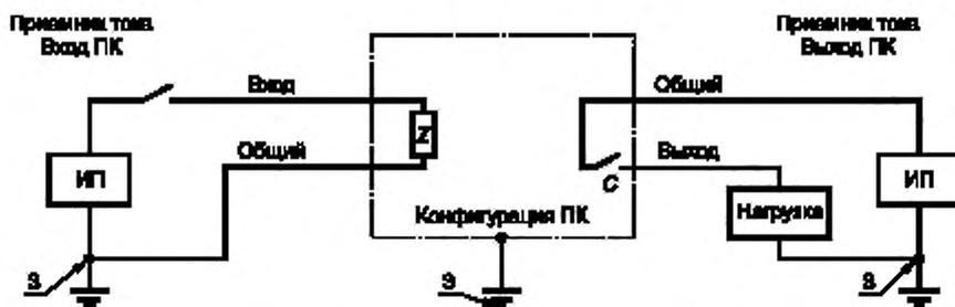
С — выход; механический или статический контакт (например, сухой контакт реле, тиристор, транзистор и т. п.); З — заземление; необязательно, или определяется национальными правилами и/или нуждами применения; Z — вход, входное полное сопротивление; ИП — внешние источники питания
