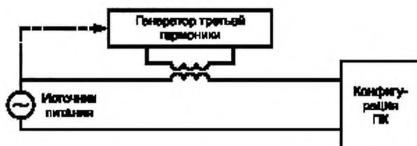
Рисунок 10 — Испытание на устойчивость к напряжению третьей гармоники
