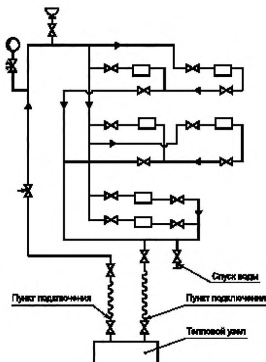
Рисунок Б.4 — Типовая схема двухпроводной СЖО
