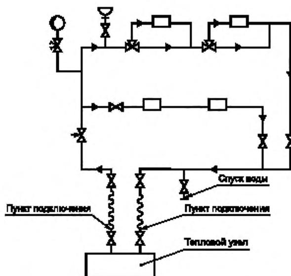
Рисунок Б.5 — Типовая схема однопроводной СЖО
