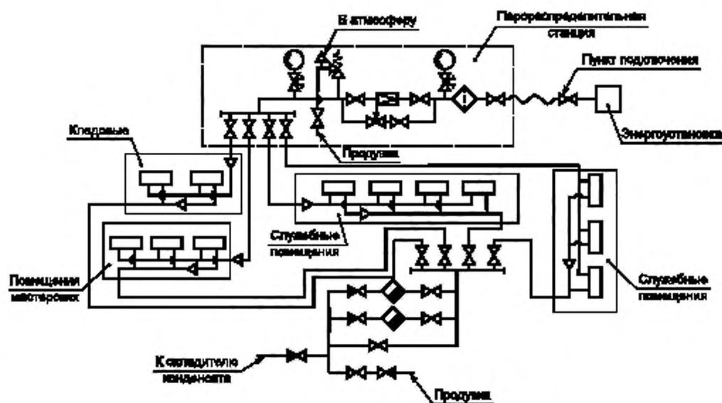
Рисунок Б.2 — Типовая схема двухпроводной прямой СПО
