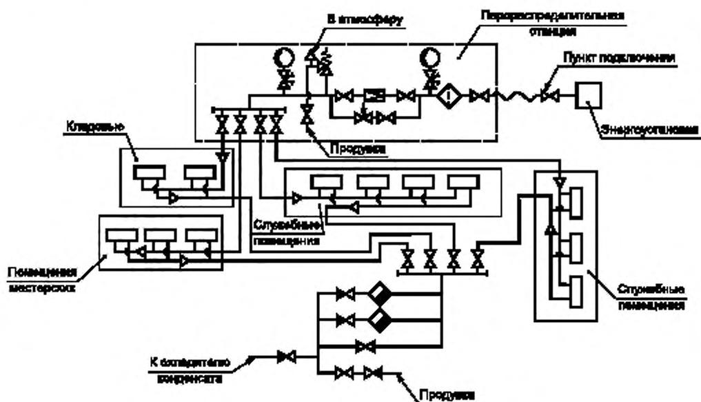
Рисунок Б.3 — Типовая схема двухпроводной противовихровой СПО
