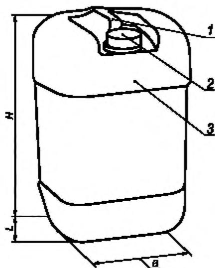
1 — ручка, прикрепленная к корпусу; 2 — колпачок; 3 — корпус
