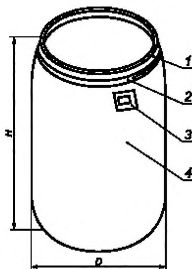
1 — крышка; 2 — обруч; 3 — ручка, встроенная в корпус; 4 — корпус
