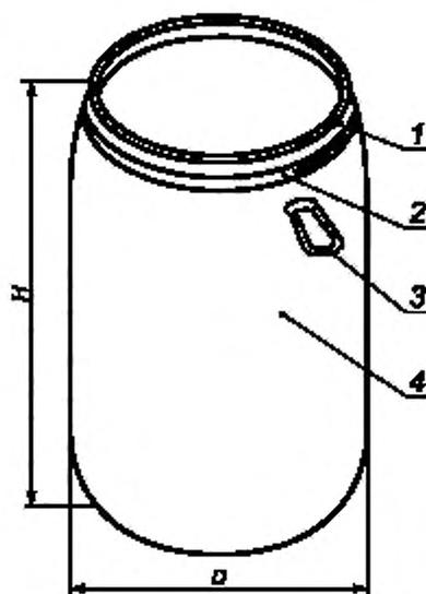
1 — крышка; 2 — обруч; 3 — ручка, прикрепленная к корпусу; 4 — корпус
