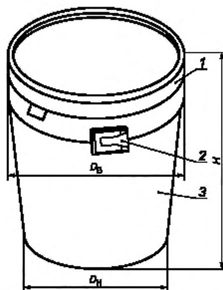
1 — крышка; 2 — ручка, встроенная в корпус; 3 — корпус
