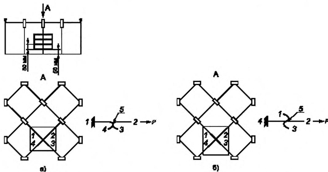
1—4 — расположение образцов при отборе из геомодуля и проведении испытаний
