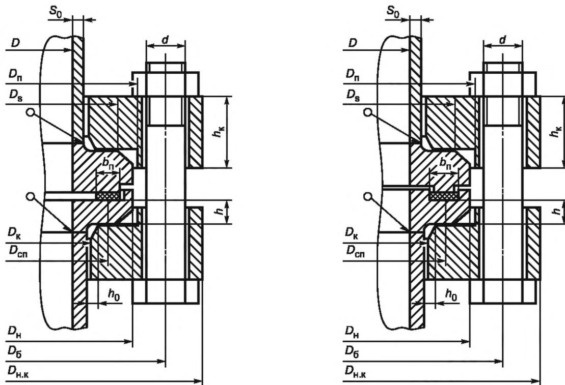
а — фланцевое соединение с уплотнительной поверхностью типа выступ — впадина
