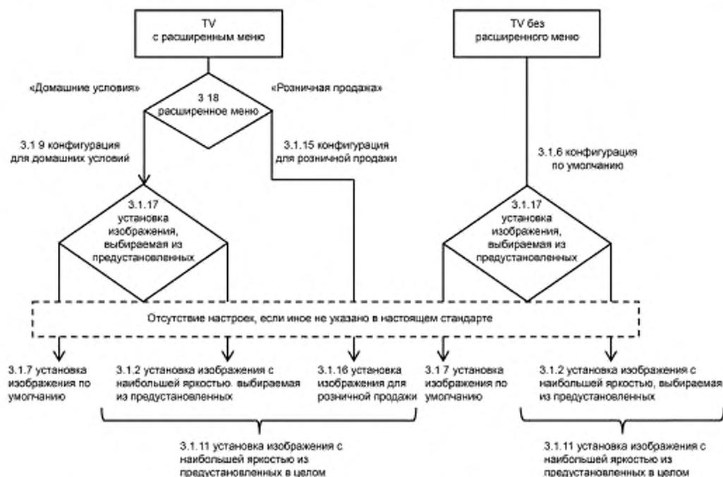
Рисунок 1 — Конфигурации и установки изображения. Концептуальная структура
