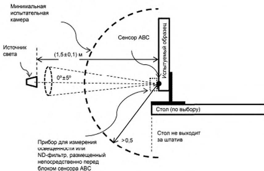
Рисунок 4 — Конфигурация источника света
