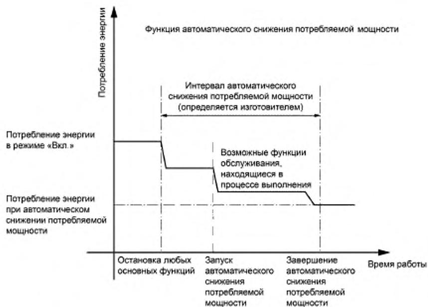
Рисунок 6 — Функция автоматического снижения потребляемой мощности
