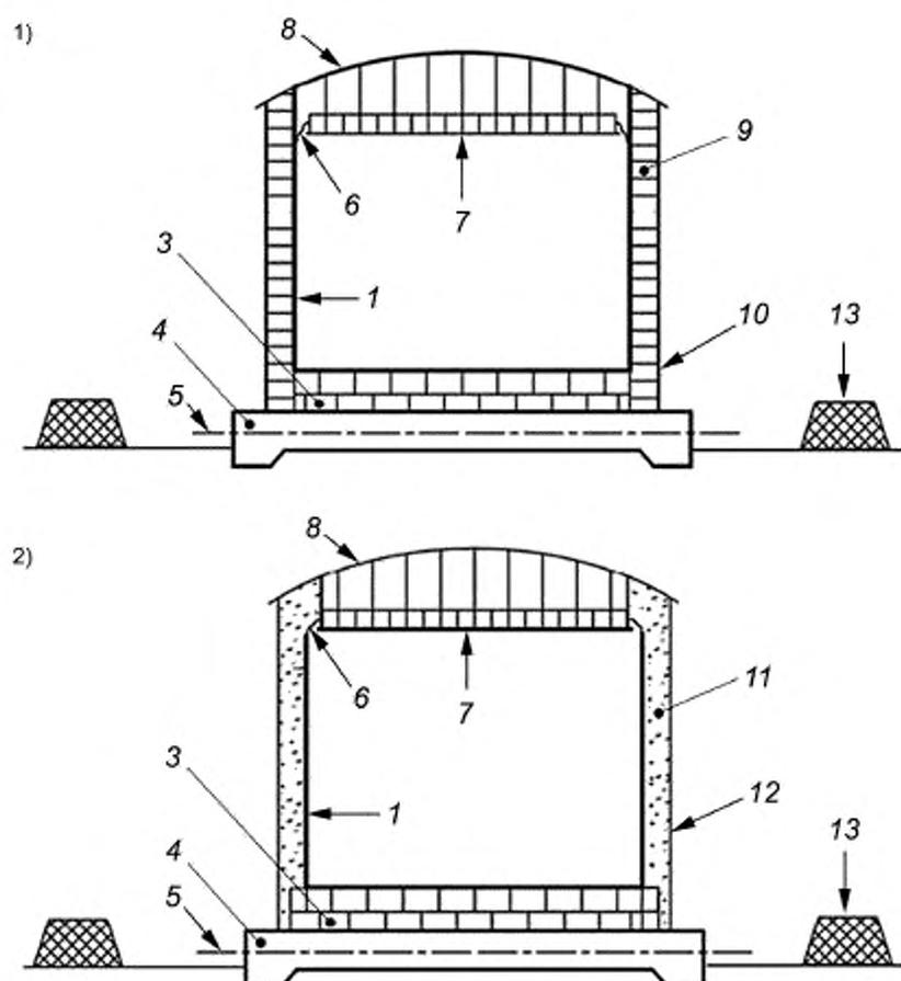
1 — первичный контейнер (стальной); 3 — изоляция дна; 4 — фундамент; 5 — система обогрева фундамента; 6 — гибкое изоляционное уплотнение; 7 — подвесное перекрытие (изолированное); 8 — крыша (стальная); 9 — наружная изоляция оболочки; 10 — наружная водо- и пароизоляция; 11 — засыпная изоляция; 12 — наружная стальная оболочка (неспособная удерживать жидкость); 13 — защитная дамба
