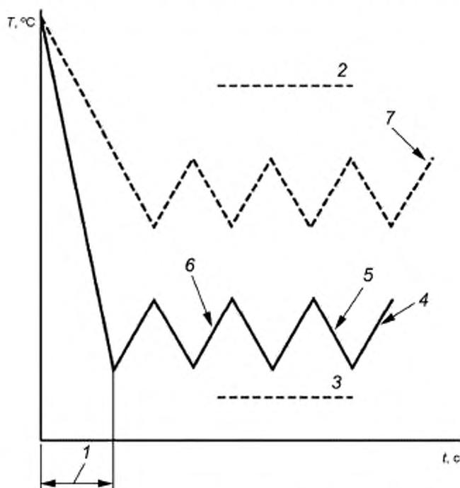
1 — период охлаждения; 2 — заданный уровень предупреждения (высокая температура); 3 — заданный уровень предупреждения (низкая температура); 4 — контрольный датчик; 5 — обогрев выключен; 6 — обогрев включен; 7 — другой датчик
