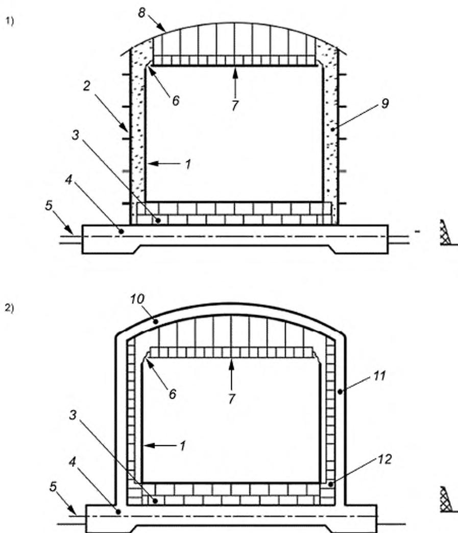
1 — первичный контейнер (стальной); 2 — вторичный контейнер (стальной); 3 — изоляция дна; 4 — фундамент; 5 — система обогрева фундамента; 6 — гибкое изоляционное уплотнение; 7 — подвесное перекрытие (изолированное); 8 — крыша (стальная); 9 — засыпная изоляция; 10 — железобетонная крыша; 11 — внешний резервуар из предварительно напряженного железобетона (вторичный контейнер); 12 — изоляция внутри внешнего резервуара из предварительно напряженного железобетона
