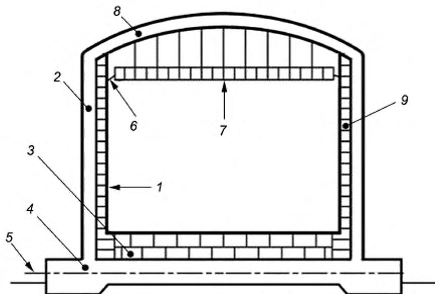
1 — первичный контейнер (мембрана), 2 — вторичный контейнер (железобетонный); 3 — изоляция дна, 4 — фундамент; 5 — система обогрева фундамента; 6 — гибкое изоляционное уплотнение; 7 — подвешенное перекрытие (изолированное); 8 — железобетонная крыша; 9 — изоляция внутри внешнего резервуара из предварительно напряженного железобетона
