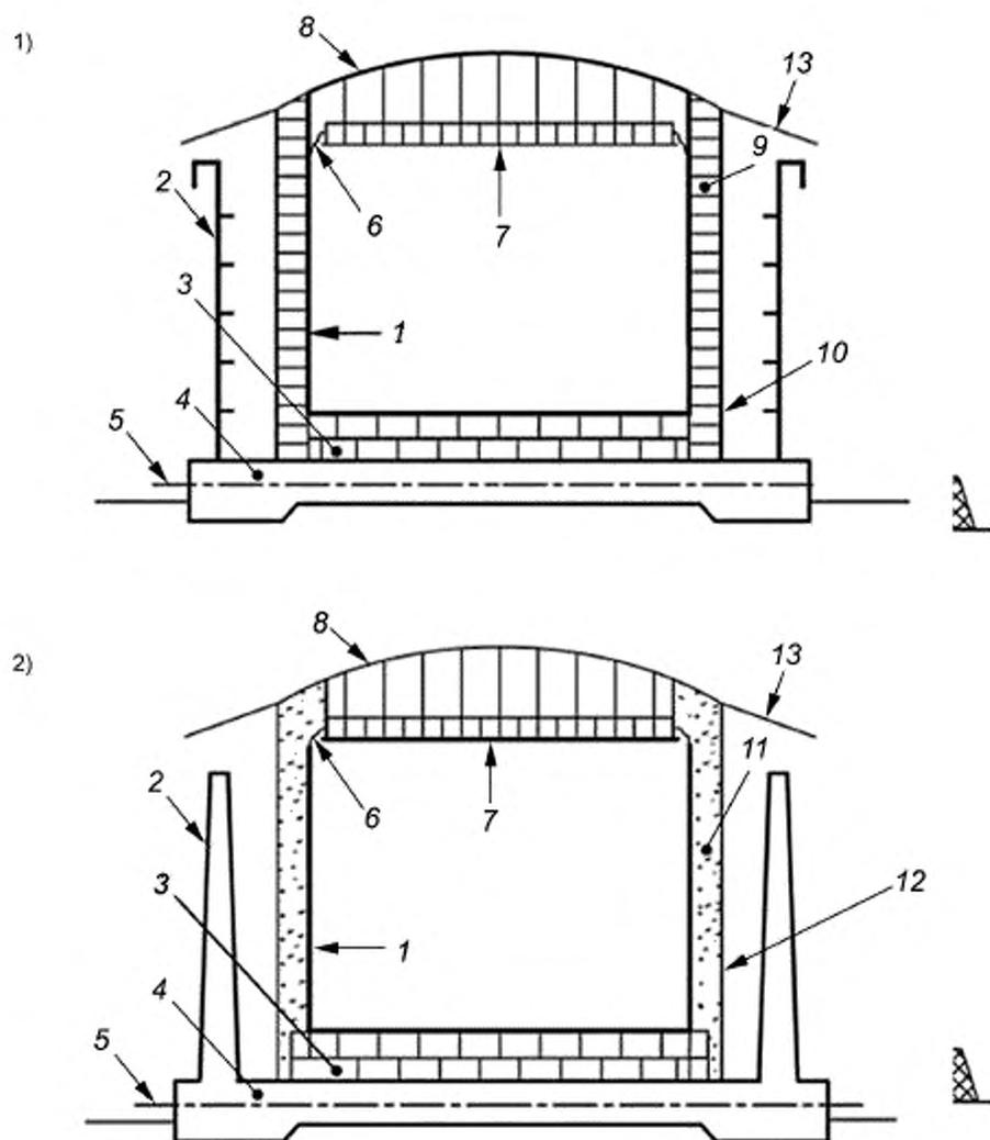
1 — первичный контейнер (стальной); 2 — вторичный контейнер (стальной или бетонный); 3 — изоляция дна; 4 — фундамент; 5 — система обогрева фундамента; 6 — гибкое изоляционное уплотнение; 7 — подвесное перекрытие (изолированное); 8 — крыша (стальная); 9 — наружная изоляция; 10 — наружная водо- и пароизоляция; 11 — засыпная изоляция; 12 — внешняя оболочка (неспособная удерживать жидкость); 13 — покрытие (дождевой щит)
