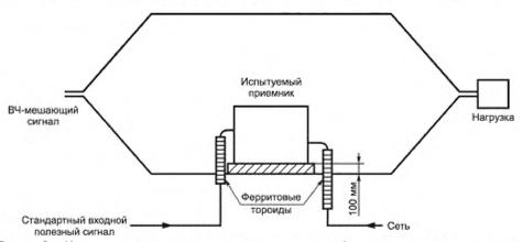
Рисунок 6 — Измерительная установка для измерения помехоустойчивости вещательных приемников по отношению к окружающим электромагнитным полям в полосе частот от 0,15 до 150 МГц
