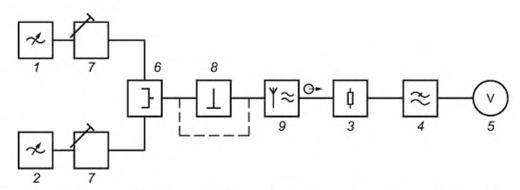
1 — генератор мешающего сиснала G1; 2 — генератор полезного сигнала G2; 3 — нагрузочныя резистор R<sub>L</sub>; 4 — фильтр нижних частот; 5 — вольтметр звуковой частоты (со схемой взвешивания в соответствии с Рекомендацией 468 МККР); 6 — схема связи; 7 — аттенюаторы; 8 — согласующая и/или симметрирующая схема, 9 — испытуемое оборудование (ИО)
