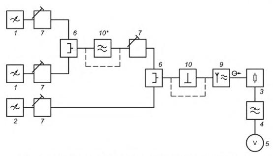
1 — генераторы мешающего сигнала G1; 2 — генератор полезного сигнала G2, 3 — нагрузочный резистор R<sub>L</sub>.
