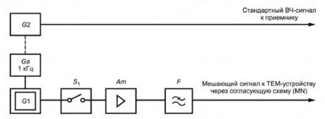
Рисунок 7 — Схема измерения помехоустойчивости звуковых вещательных приемников к окружающим ЭМ полям
