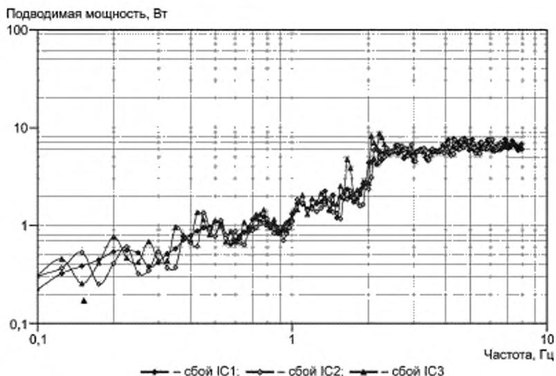
Рисунок 8 — Результаты измерения зависимости пороговых значений восприимчивости интегральной схемы DW74LSOON (TTL) quad2-input NAND от частоты, иллюстрирующие возрастание пороговых значений восприимчивости с повышением частоты
