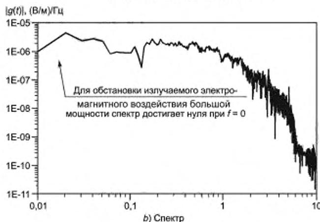
Рисунок 3 — Пример широкополосного переходного процесса электромагнитного воздействия большой мощности вместе с его спектральным представлением
