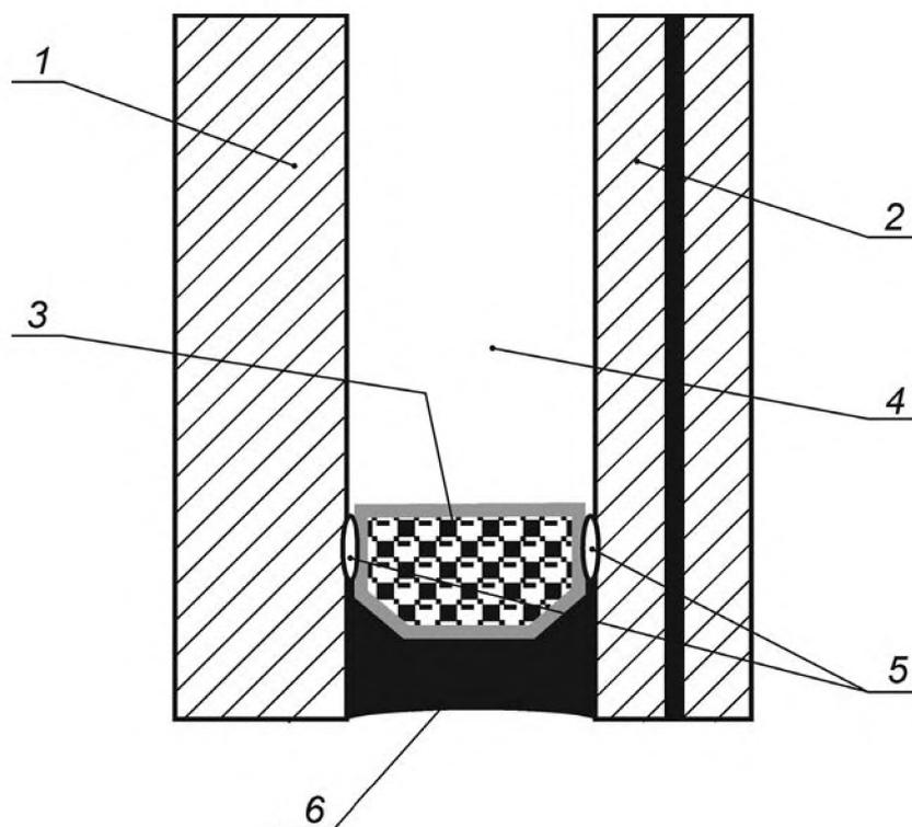
Тип 10-16-8 с многослойным стеклом с звукопоглощающим промежуточным слоем *S*, заполнение воздухом
