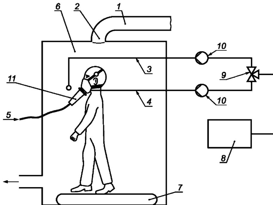
1 — труба; 2 — заслонка; 3 — пробоотборник в камере; 4 — пробоотборник в дыхательной зоне;
