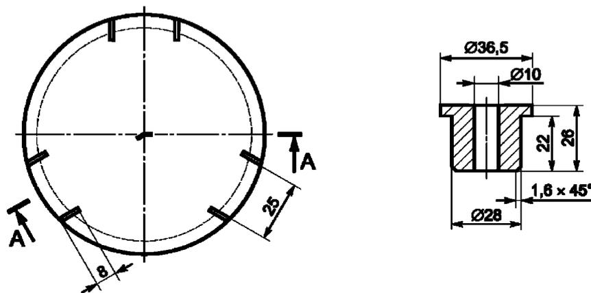
Рисунок 12, лист 2 — Конструкция распылителя
