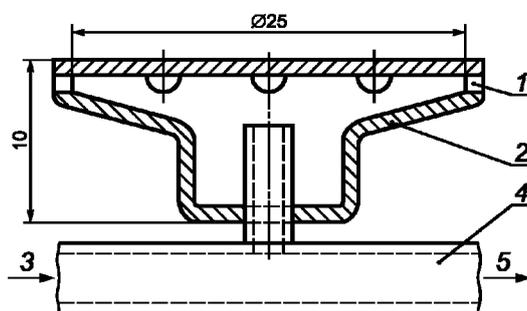
1 — восемь отверстий диаметром 2 мм, расположенных равномерно; 2 — внутренний диаметр около 9 мм;
