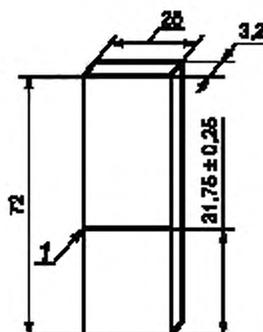
1 — обработанная машинным способом канавка. 0,8 мм
