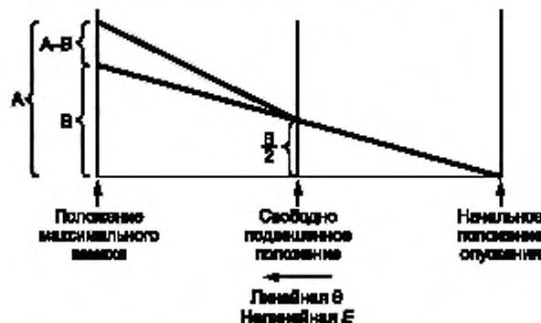
А — коэффициент, характеризующий общую потерянную энергию; В — коэффициент, характеризующий энергию, потерянную маятником на трение в подшипнике и сопротивление воздуха
