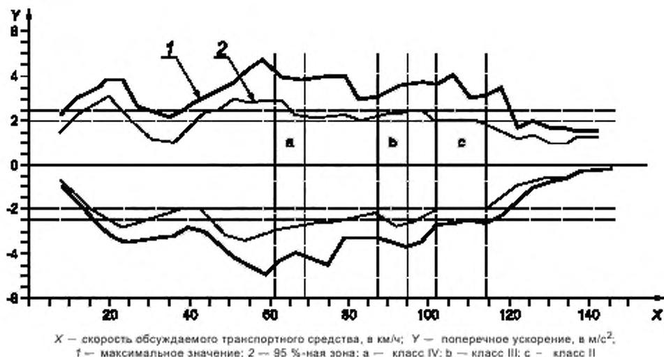
Рисунок 5 — Поперечное ускорение для среднего водителя
