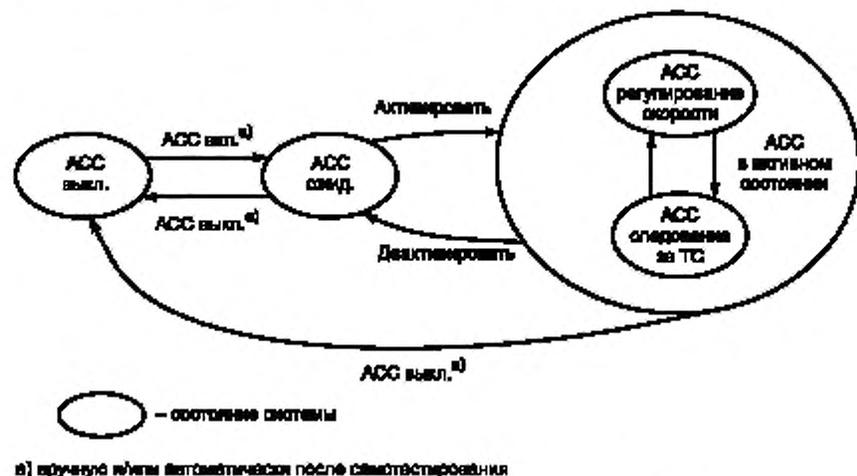
Рисунок 2 — Состояния и переходы системы ACC
