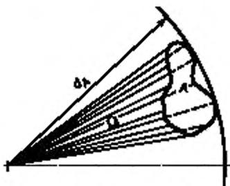
Рисунок А.1 — Телесный угол
