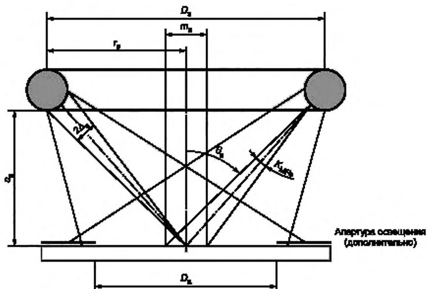
$2\Delta_s$  — стягивание кольцевого светильника,  $\theta_s$  — наклон кольцевого светильника;
