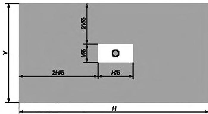
Рисунок 15 — Таблица дисплея, используемая для снятия характеристик двоения
