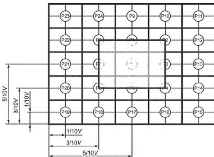
Рисунок 9 — Прямоугольное окно при измерении перекрестной помехи
