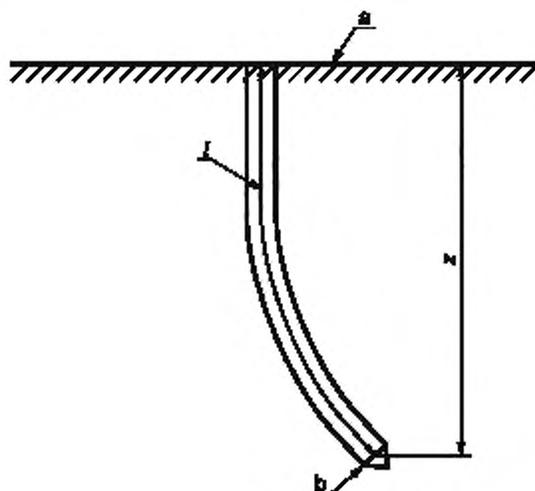
$a$  — неподвижная горизонтальная плоскость;  $b$  — основание конической части конуса;  $l$  — длина зондирования;
