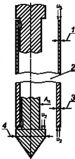
1 — площадь поперечного сечения (верхняя часть)  $A_{st}$ ; 2 — площадь поверхности муфты трения  $A_c$ ;
