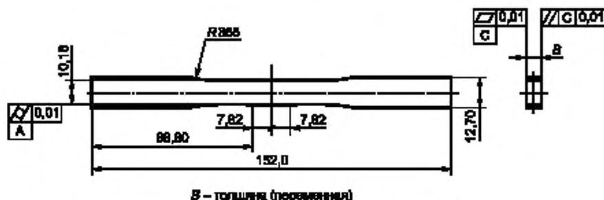
Рисунок 4 — Образец типа IV
