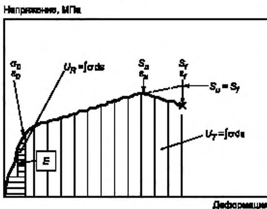
$\sigma_0$  — напряжение на пределе пропорциональности;  $\epsilon_0$  — деформация на пределе пропорциональности;
