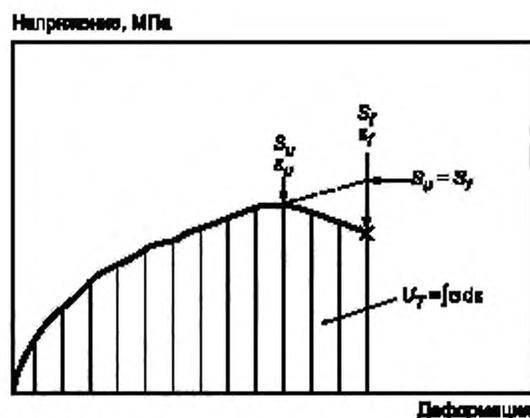
$S_u$  — предел прочности при растяжении;  $S_f$  — предел прочности при разрыве.  $U_T$  — удельная работа растяжения
