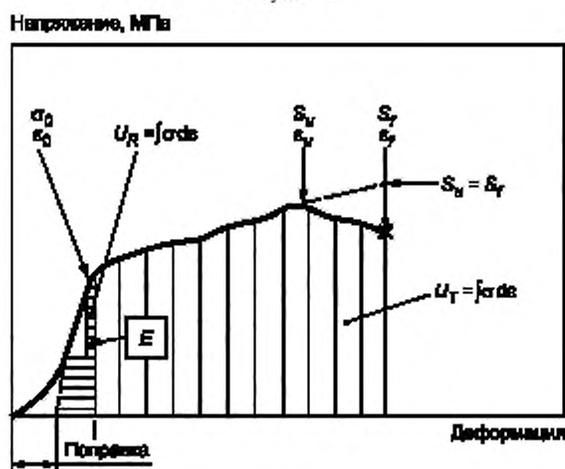
$\sigma_0$  — напряжение при пределе пропорциональности;  $\varepsilon_0$  — деформация;  $S_u$  — предел прочности при растяжении;  $S_f$  — предел прочности при разрыве;  $U_R$  — удельная потенциальная энергия растяжения;  $U_T$  — удельная работа растяжения;  $E$  — модуль упругости при растяжении
