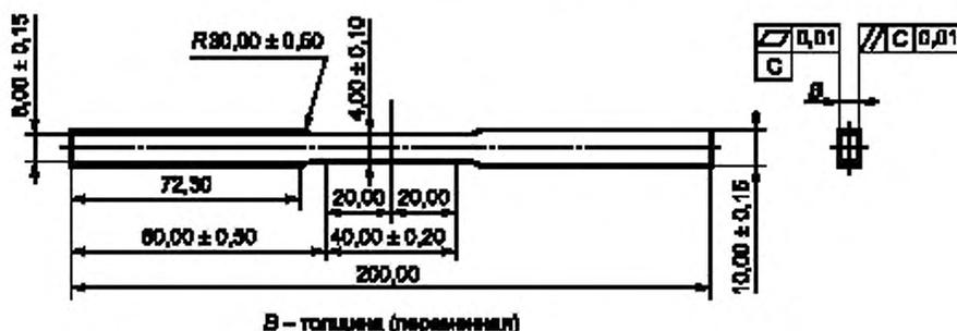
Рисунок 5 — Образец типа V
