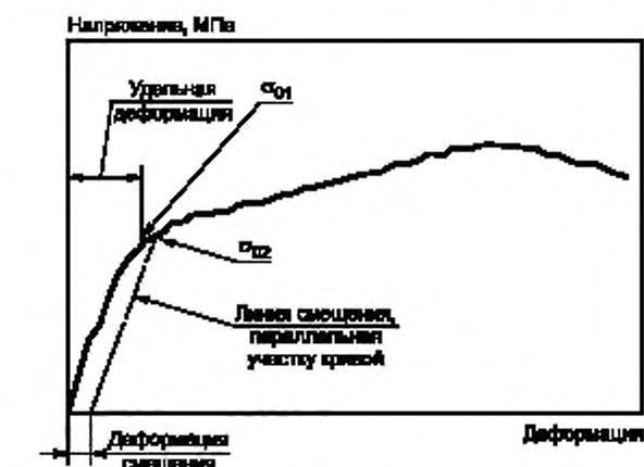
$\sigma_{01}$  — напряжение на пределе пропорциональности, полученное по 7.5.2;
