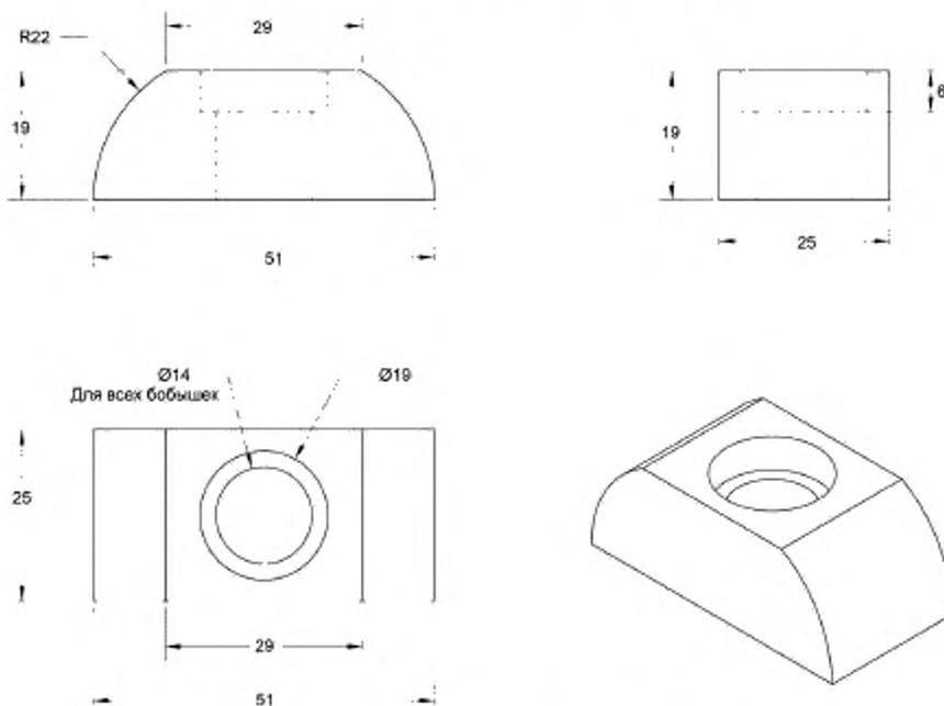
Рисунок 2 — Конструкция вертлужной бобышки
