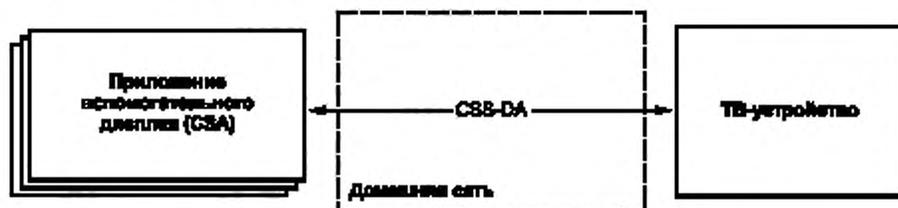
Рисунок 5 — Интерфейс обнаружения и взаимодействия DA
