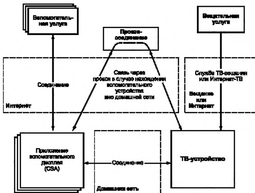
Рисунок 2 — Базовая архитектура составной предоставляемой услуги
