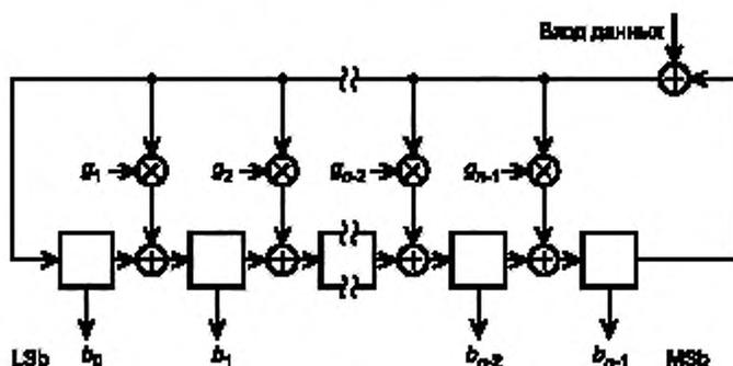
Рисунок А.1 — Схема генерации CRC
