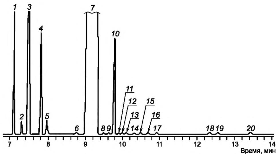
1 — пропан; 2 — пропадиен; 3 — изобутан; 4 — *n*-бутан; 5 — 2,2-дибутилпропан; 6 — 3-метилбутен-1; 7 — изопентан; 8 — пентен-1; 9 — 2-метилбутен-1; 10 — *n*-пентан; 11 — изопрен; 12 — *транс*-бутен-2; 13 — 3,3-диметилбутен; 14 — *цис*-бутен-2; 15 — 2-метилбутен-2; 16 — *транс*-пентадиен-1,3; 17 — 2,2-диметилбутан; 18 — циклопентан; 19 — 2-метилпентан; 20 — 3-метилпентан
