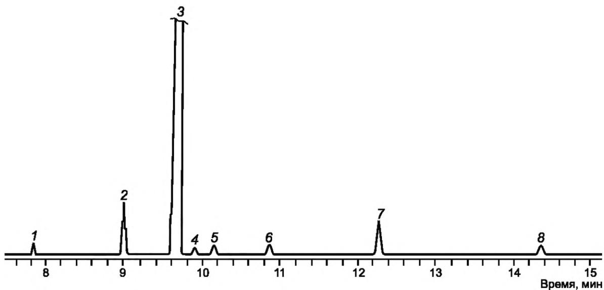
1 — *n*-бутан; 2 — изопентан; 3 — *n*-пентан; 4 — *транс*-пентен-2; 5 — *цис*-пентен-2;
