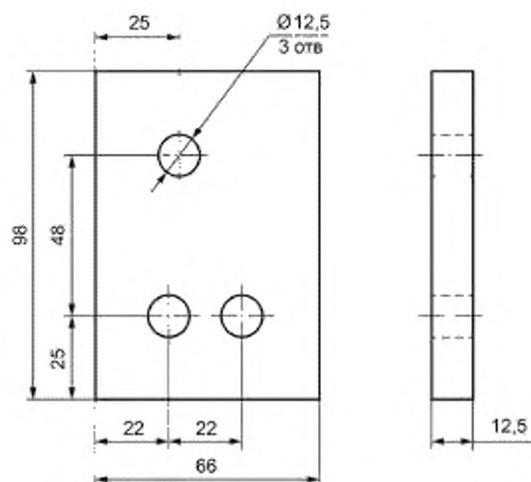
Рисунок ДА.3 — Эскиз выравнивающей пластины
