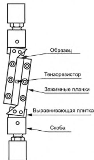
Рисунок 1 — Метод А. Приспособление для сдвига
