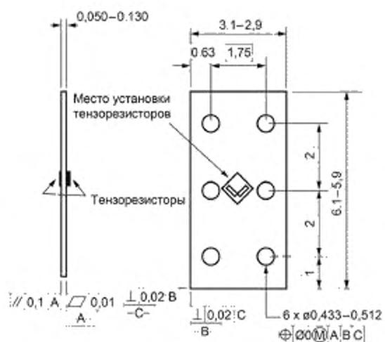
Рисунок 7 — Метод А. Образец, размеры в дюйм-фунт
