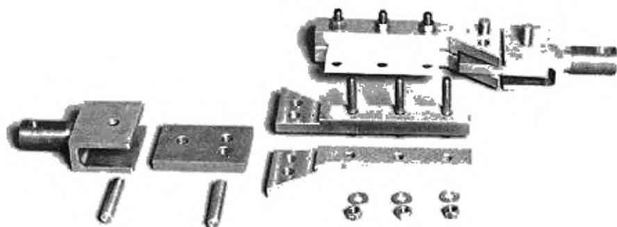
Рисунок 3 — Приспособление для испытаний по методу А
