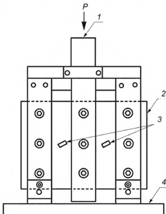
$P$  — нагрузка, 1 — центральная планка, установленная через прорезь; 2 — образец;
