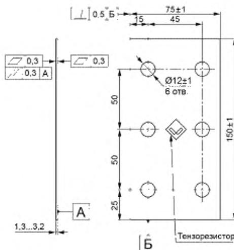
Рисунок 5 — Эскиз образца, испытываемого по методу А
