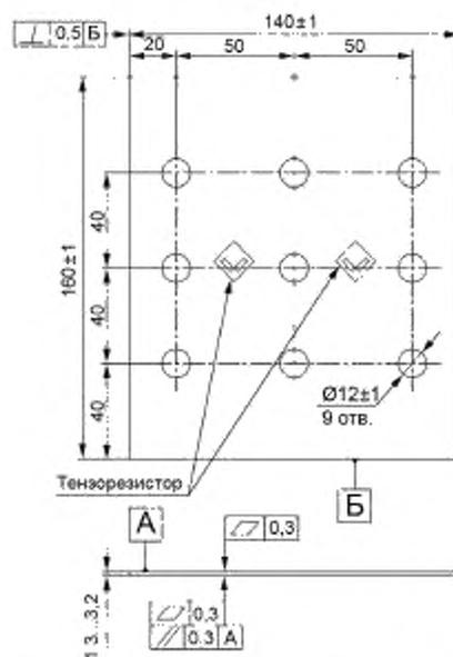
Рисунок 6 — Эскиз образца, испытываемого по методу В
