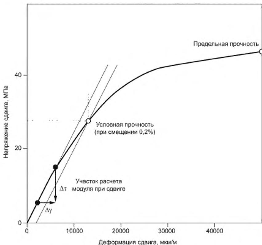
Рисунок 7 — Пример кривой «напряжение сдвига — деформация сдвига»
