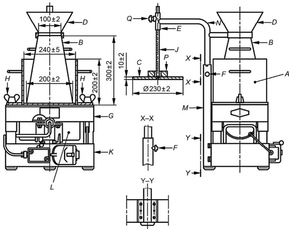
A — емкость; B — форма; C — прозрачный диск; D — воронка; E — направляющая муфта; F — винт; G — виброплощадка; H — винт барашковый; J — стержень с измерительной шкалой; K — полое основание; L — вибрирующий элемент; M — держатель; N — поворотный кронштейн; P — пригруз; Q — винт; Y-Y — деталь; X-X — деталь
