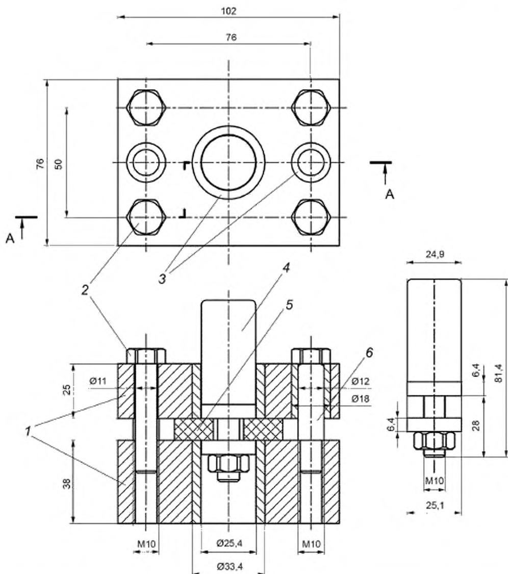
1 — верхняя и нижняя части приспособления для испытаний; 2 — зажимные болты; 3 — закаленные втулки; 4 — пуансон;
