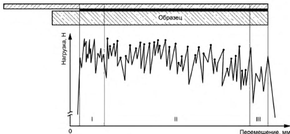
Рисунок 4 — Образец и диаграмма, полученная в ходе испытания
