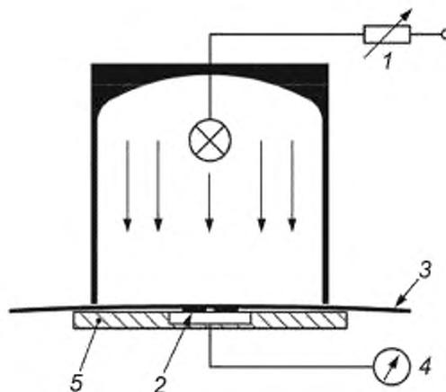
1 — источник переменного питания; 2 — фотозлемент; 3 — испытуемый кусок полимерной пленки; 4 — люксметр;
