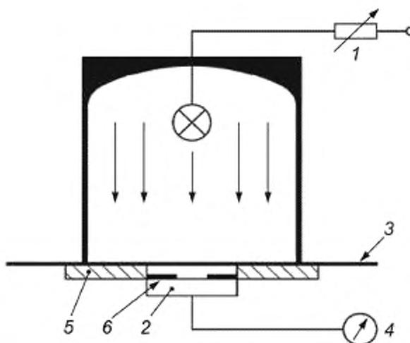
1 — источник переменного питания; 2 — фотозлемент; 3 — испытуемый кусок полимерной пленки; 4 — люксметр;
