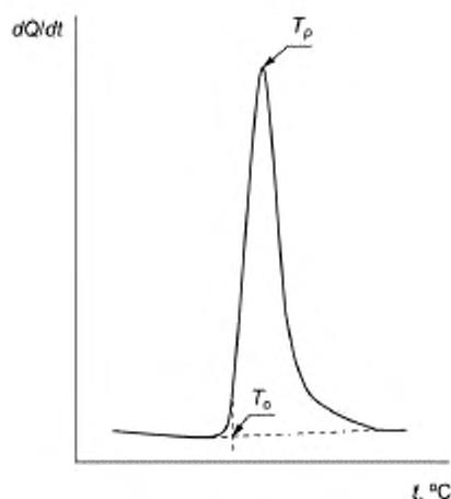
Рисунок 1 — Типовая кривая экзотермического отверждения
