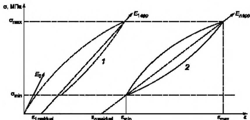
1 — первый цикл нагружения, 2 —  $n$ -й цикл нагружения
