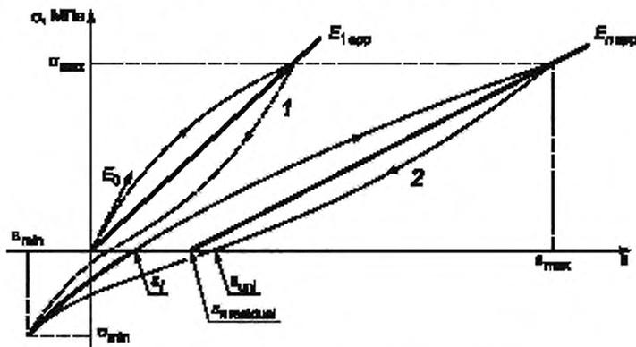
1 — первый цикл нагружения; 2 —  $n$ -й цикл нагружения
