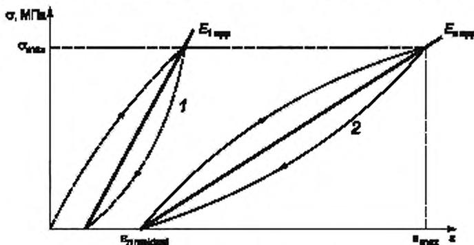
1 — первый цикл нагружения; 2 —  $n$ -й цикл нагружения
