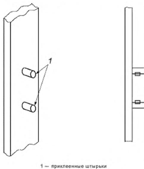
Рисунок А.1 — Пример образца для оптической тензометрии
