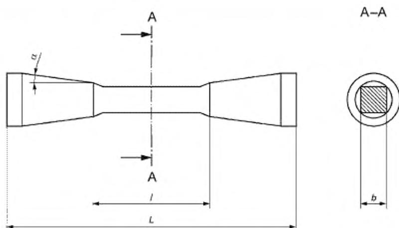
$l$  — длина узкой параллельной части;  $L$  — общая длина;  $\alpha$  — угол,
