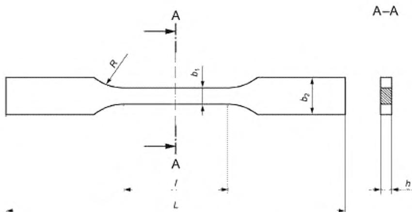
$l$  — длина узкой параллельной части;  $L$  — общая длина;  $h$  — толщина,
