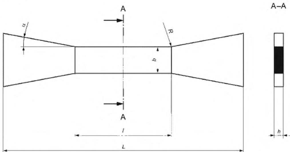
$l$  — длина узкой параллельной части,  $L$  — общая длина;  $h$  — толщина;  $\alpha$  — угол;
