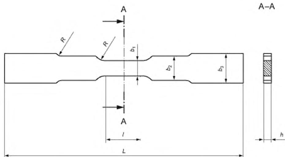
$l$  — длина узкой параллельной части,  $L$  — общая длина;  $h$  — толщина;
