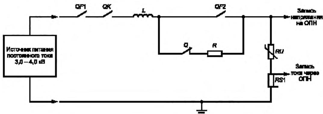
QF1 — защитный выключатель; QF2 — рабочий быстродействующий выключатель постоянного тока; QK — короткозамыкатель; R — добавочный резистор для регулировки величины тока; L — воздушный реактор; Q — коммутационный аппарат постоянного тока; RS1 — измерительный импульсный шунт; RU — испытуемый ограничитель перенапряжений
