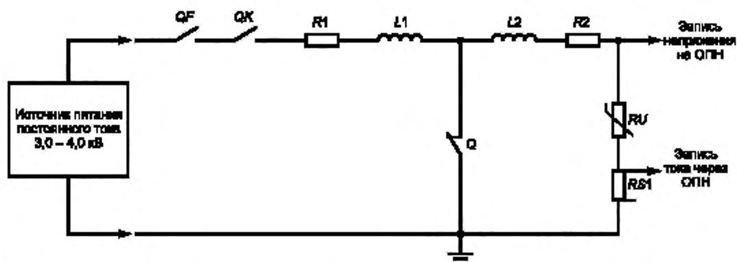
QF — защитный выключатель; QK — короткозамыкатель; R1, R2 — добавочные резисторы для регулировки амплитуды импульса тока; L1, L2 — воздушные реакторы для регулировки длительности импульса тока; Q — прерыватель постоянного тока; RS1 — измерительный импульсный шунт; RU — испытуемый ограничитель перенапряжений
