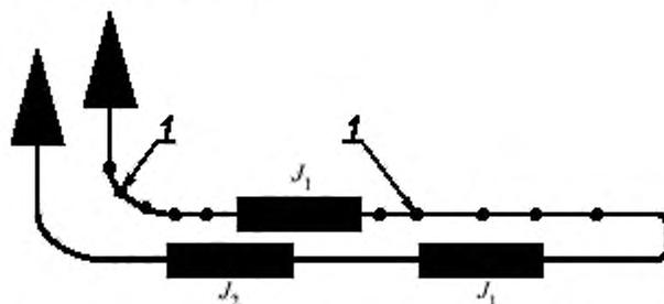
1 — зажим;  $J_1$  — соединительная муфта для негибкого (стационарного) и гибкого крепления;
