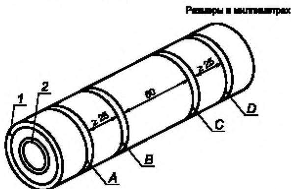
1 — экран по изоляции; 2 — экран по жиле; А, D — электроды тока; В, С — электроды напряжения
