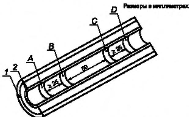
1 — экран по изоляции; 2 — экран по жиле; А, D — электроды тока; В, С — электроды напряжения
