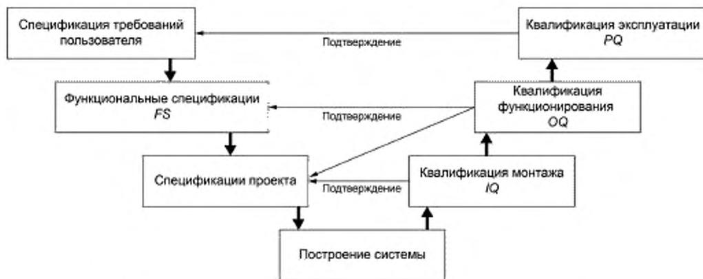
Рисунок 2 — Примерная схема взаимосвязи между ключевыми спецификациями и этапами квалификации в процессе проектирования, построения и тестирования системы<sup>2)</sup>
