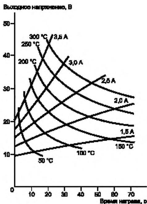
Рисунок А.1 — Пример графиков «напряжение—время» и изотермических графиков для образцов провода в виде макета скрученной обмотки с жилой номинальным диаметром 0,300 мм
