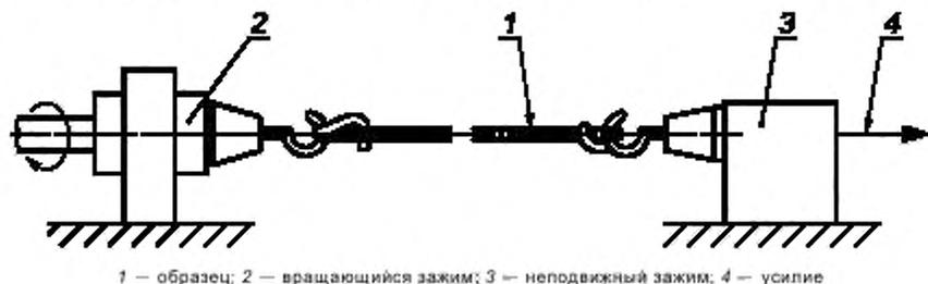
Рисунок 6 — Устройство для испытания на отслаивание
