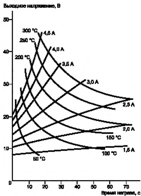
Рисунок А.2 — Пример графиков «напряжение—время» и изотермических графиков для образцов провода в виде макета скрученной обмотки с жилой номинальным диаметром 0,315 мм
