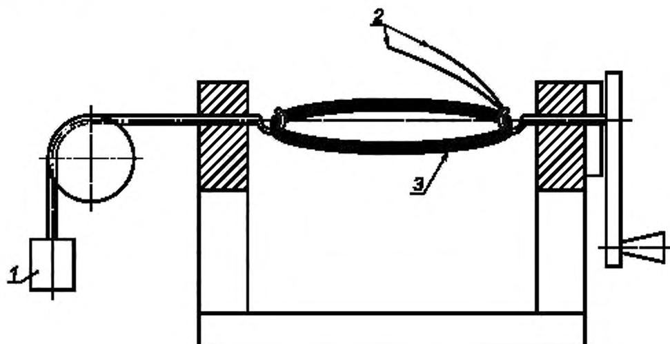
1 — нагрузка; 2 — постоянный ток; 3 — скручиваемый образец
