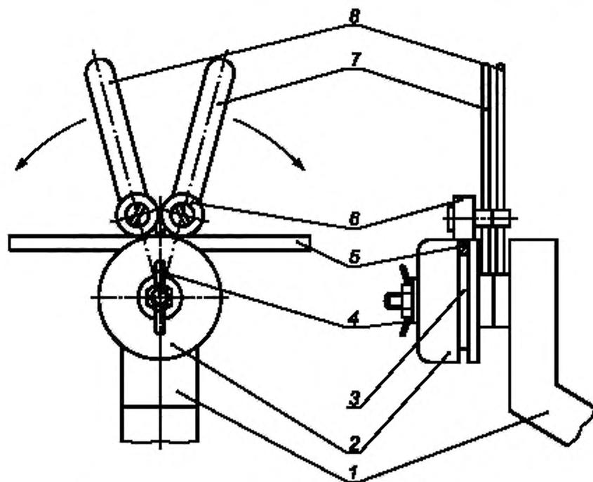
1 — опорная стойка, 2 — зажимное кольцо стержня; 3 — стержень; 4 — гайка-барашек; 5 — образец;
