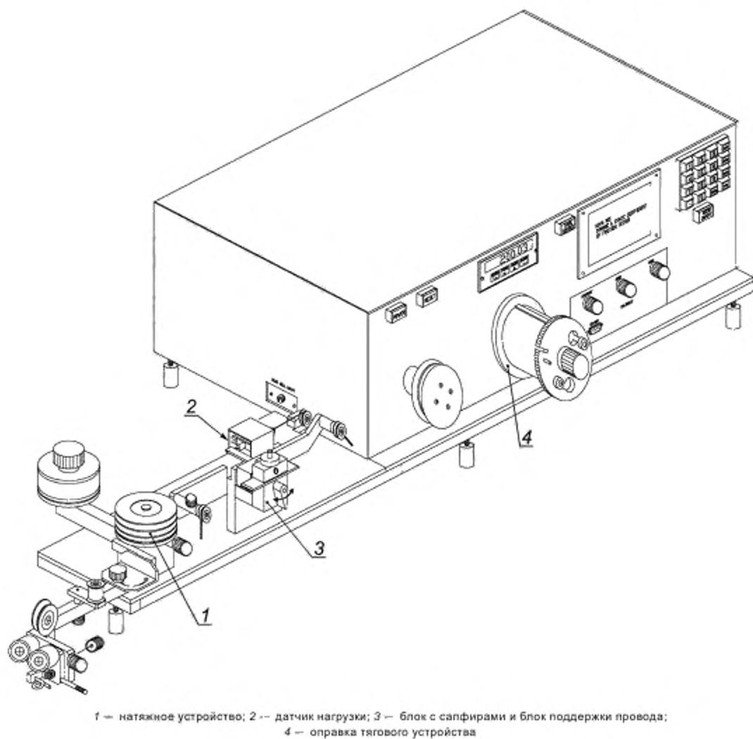
Рисунок В.3 — Типовое испытательное устройство для определения динамического коэффициента трения
