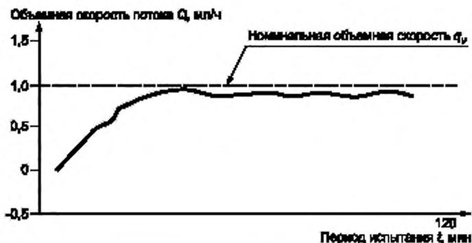
Рисунок А.2 — Пример данных, полученных в течение первых 2 ч испытания
