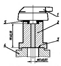
I — испытуемый выносной телефон; 2 — эквивалент ушного вкладыша; 3 — опорная плоскость имитатора закрытого ука; 4 — имитатор закрытого ука; 5 — герметизирующее и фиксирующее уплотнение
