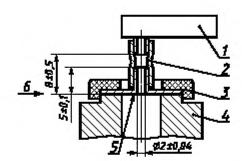
I- слуховой аппарат (модульной конструкции), 2- соединительная трубка; 3- фиксатор; 4- имитатор закрытого уха; 5- наконечник;  $\delta-$  опорная плоскость имитатора закрытого уха
