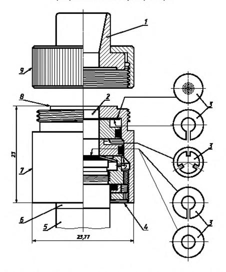
I- имитатор наружного уха; 2- пылезащитное приспособление; 3- прокладка, 4- отверстия для вырхвинвания давления; 5- предусилитель микрофона; 6- микрофон; 7- корпус; 8- опорная плоскость; 9- гайка с накаткой
