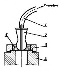
І — трубка, 2 — ушной вкладыш; 3 — опорная плоскость имитатора закрытого уха; 4 — имитатор закрытого уха; 5 — герметизирующее и фиксирующее уплотнение
