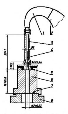
I — звукопровод; Z — слуховой аппарат; S — соединительная трубка;  $\delta$  — наконечник; S — герметизирующее уплотиение;  $\delta$  — эквивалент ушного вкладыша; T — опорная плоскость имитатора закрытого уха; S — имитатор закрытого уха
