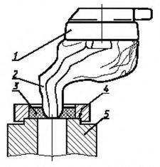
I — телефон слухового аппарата; 2 — индявидуальный ушной вкладыш; 3 — герметизирующее и фиксирующее уплотнение; 4 — опорная плоскость имитатора закрытого уха; 5 — имитатор закрытого уха
