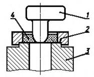
I — слуховой анпарат (изготовленный по заказу); 2 — опорная плоскость имитатора закрытого ука; 3 — имитатор закрытого ука; 4 — герметизирующее и фиксирующее углятиемие
