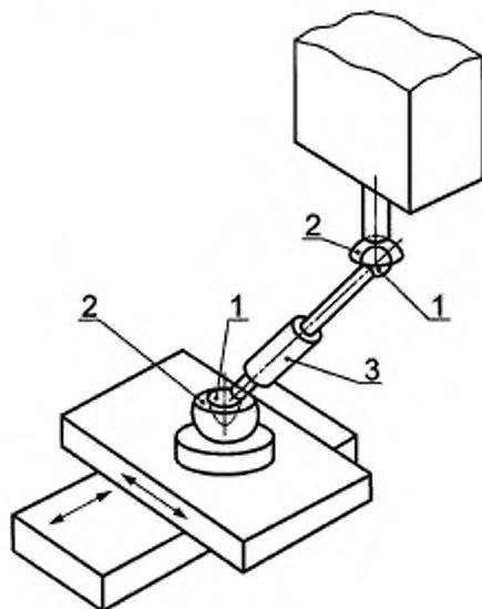
1 — телескопическая оправка со сферическими шарнирными опорами;
