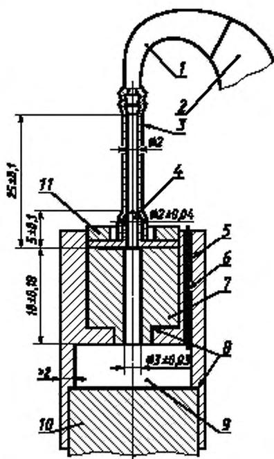
1 — звукопровод, 2 — слуховой аппарат; 3 — подводящая трубка; 4 — наконечник; 5 — капиллярная трубка диаметром 0,6 мм и длиной не менее 12,5 мм, предназначенная для выравнивания статического давления; 6 — проволока диаметром 0,5 мм; 7 — эквивалент ушного вкладыша; 8 — герметизирующее уплотнение; 9 — полость диаметром 18–21 мм [эффективный объем  $(2 \pm 0,02)$  см<sup>3</sup>]; 10 — микрофон, калиброванный по давлению; 11 — герметизирующее и фиксирующее уплотнение
