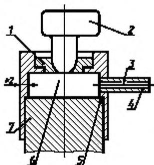
1 — герметизирующее уплотнение для слухового аппарата; 2 — внутриушной слуховой аппарат; 3 — проволока диаметром 0,5 мм; 4 — капиллярная трубка диаметром 0,6 мм и длиной не менее 12,5 мм, предназначенная для выравнивания статического давления; 5 — герметизирующее уплотнение; 6 — полость [диаметр 18–21 мм, эффективный объем  $(2 \pm 0,02)$  см<sup>3</sup>]; 7 — микрофон, калиброванный по давлению
