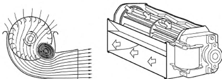
Рисунок 17 — Диаметральный вентилятор
