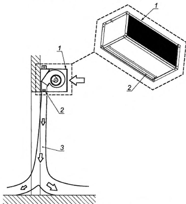
1 — агрегат воздушной завесы; 2 — выходной патрубок; 3 — воздушная завеса
