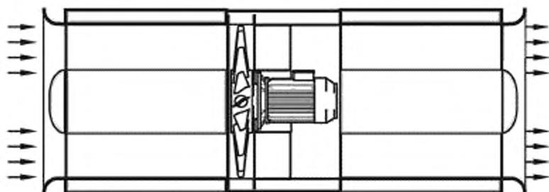
Рисунок 9 — Струйный вентилятор
