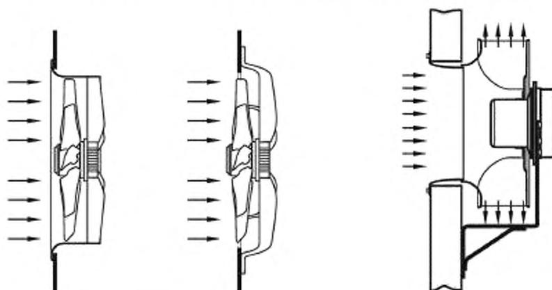
Рисунок 8 — Вентиляторы, встраиваемые в отверстие стены
