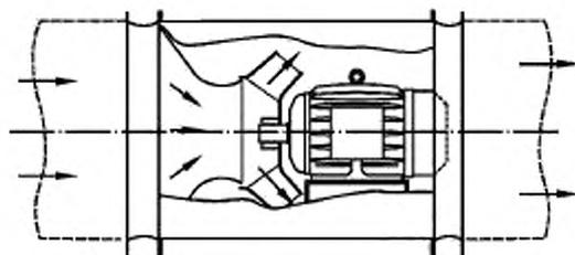
Рисунок 5 — Прямоточный диагональный вентилятор
