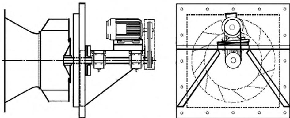
Рисунок 13 — Вентилятор для вентиляторного блока
