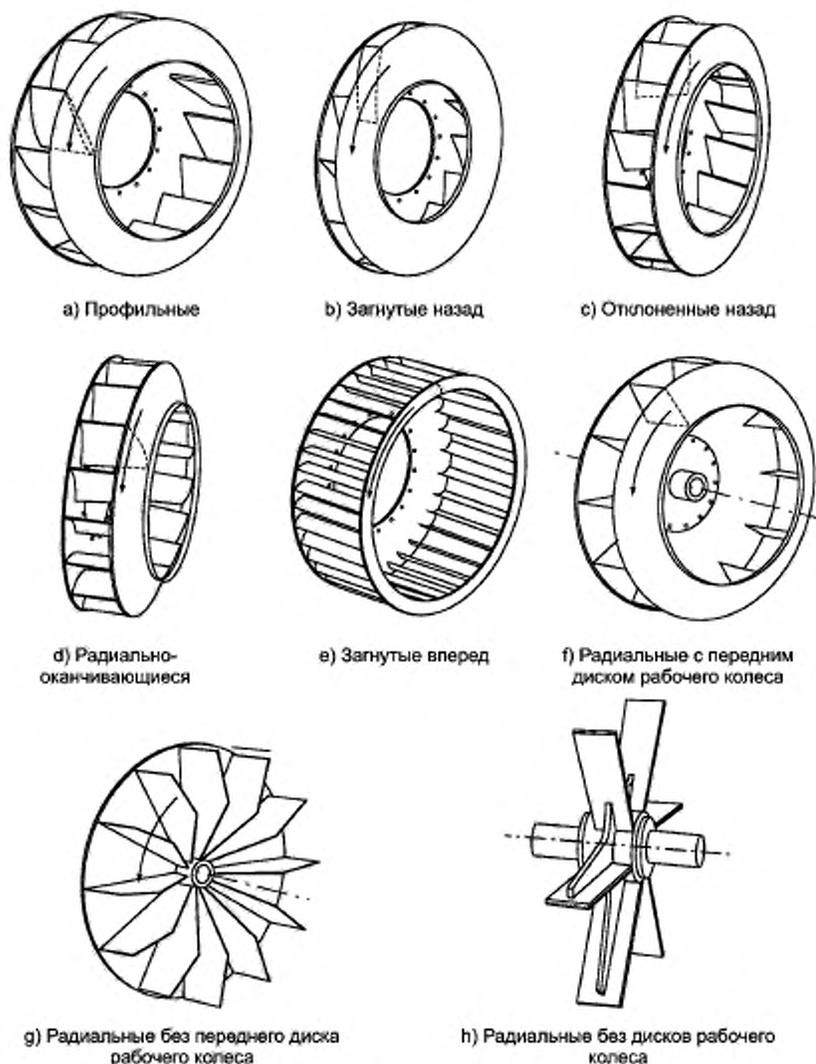
Рисунок 12 — Радиальные рабочие колеса с разными типами лопаток
