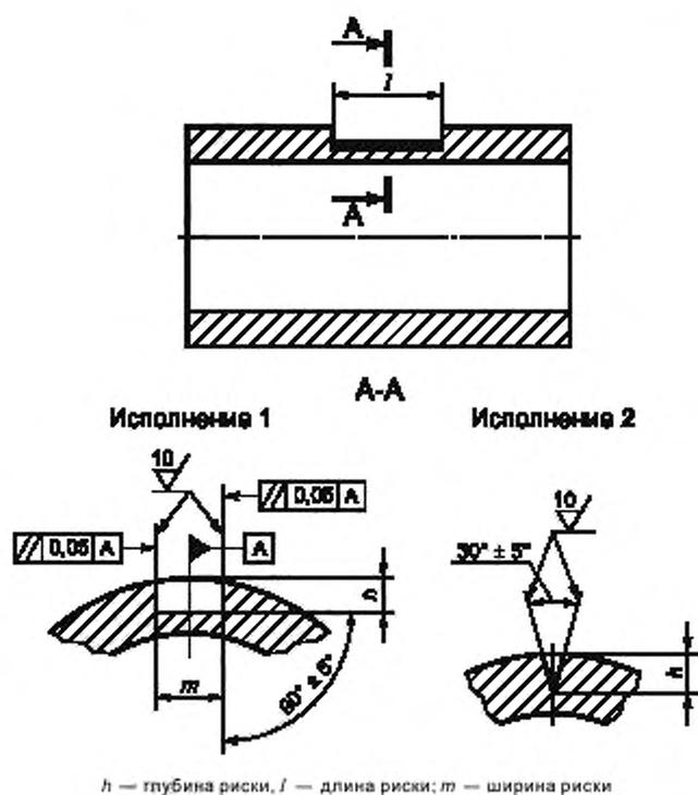
Рисунок 2 — Искусственный отражатель типа риски (наружная поверхность образца)
