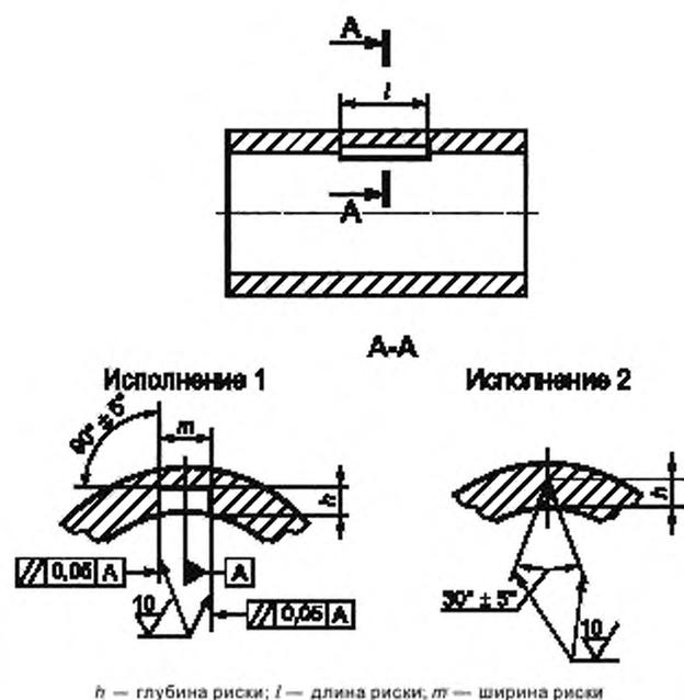
Рисунок 1 — Искусственный отражатель типа риски (внутренняя поверхность образца)
