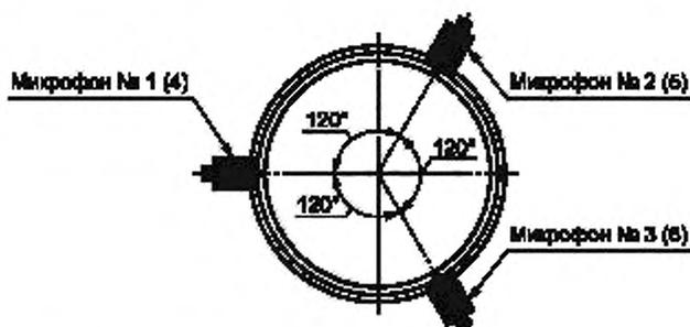
Рисунок 16 — Схема установки микрофонов на участок трубопровода
