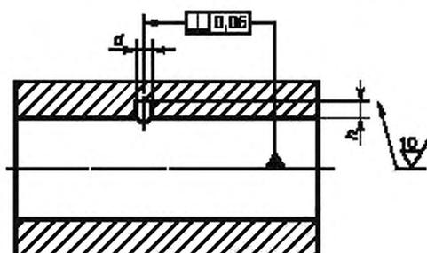
$h$  — расстояние плоского дна отверстия от внутренней поверхности трубы;  $d$  — диаметр отверстия
