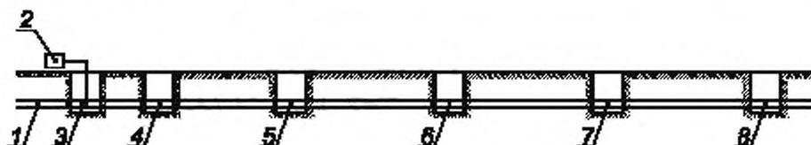
1 — трубопровод; 2 — виброакустический прибор; 3—8 — места установки микрофонов
