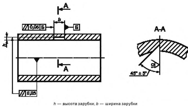
Рисунок 5 — Искусственный отражатель типа зарубки (внутренняя поверхность образца)
