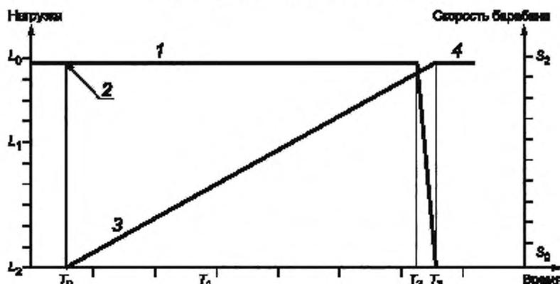
1 — испытательная нагрузка; 2 — номинальная нагрузка; 3 — испытательная скорость (линейная); 4 — номинальная скорость;  $T_0$  — время запуска цикла;  $L_2$  — нулевая нагрузка;  $S_0$  — нулевая скорость, длина пробега — 3505 м; разность  $T_3$  и  $T_2$  — не более 3
