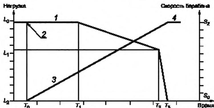
1 — испытательная нагрузка; 2 — номинальная нагрузка; 3 — испытательная скорость (линейная); 4 — номинальная скорость;  $L_1 = 0,65L_0$ ;  $L_2$  — нулевая нагрузка;  $T_0$  — время запуска цикла;  $T_1 = 20$  с;  $S_0$  — нулевая скорость; длина пробега — 1981 м, разность  $T_3$  и  $T_2$  — не более 3
