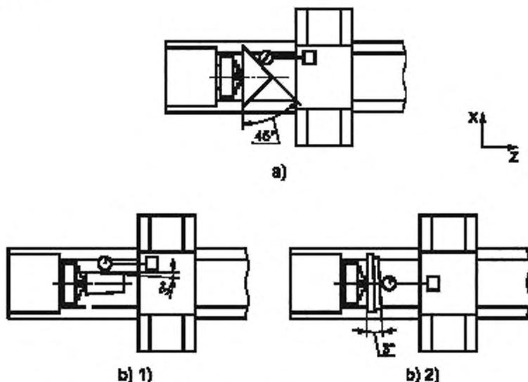
Допуск 0,020 мм для любого интервала с длиной 100 мм.
