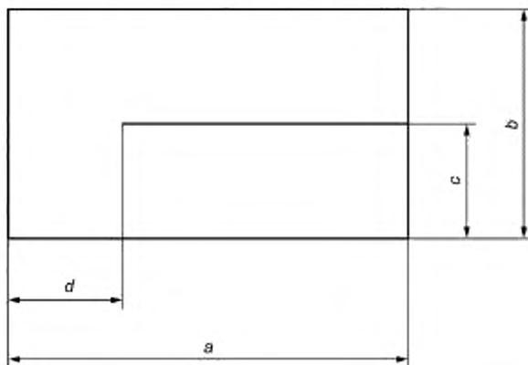
Рисунок 1 — Образец для испытания раздира по одной кромке
