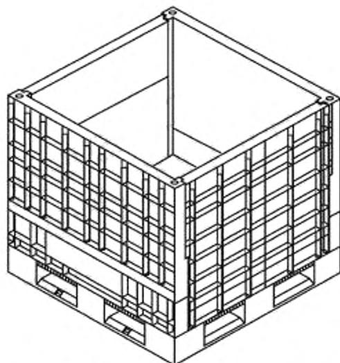
Рисунок А.3 — Ящикный поддон с решетчатыми стенками
