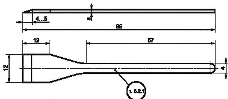
Рисунок А.2.14 — Лабораторный шпатель из платины или серебра
