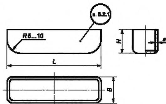
Рисунок А.2.1 — Лодочка для элементного анализа из платины
