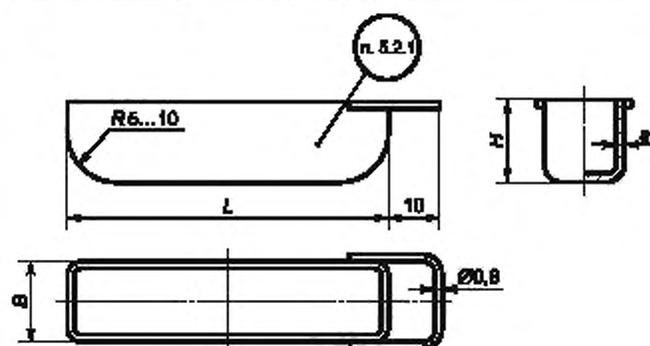
Рисунок А.2.2 — Лодочка для сжигания из платины (Изделие № 201)
