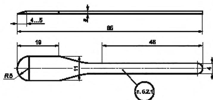
Рисунок А.2.13 — Лабораторный шпатель из платины или серебра
