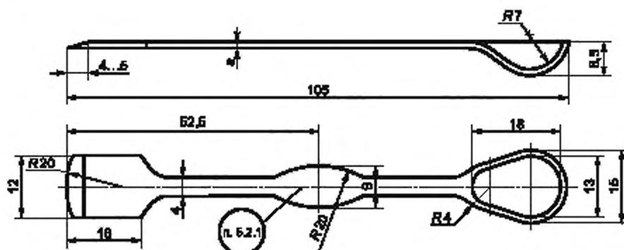
Рисунок А.2.11 — Лабораторный шпатель из платины или серебра
