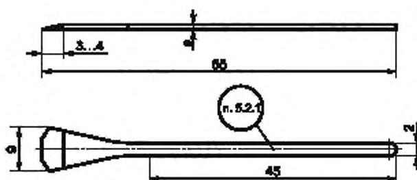
Рисунок А.2.17 — Лабораторный шпатель из платины или серебра
