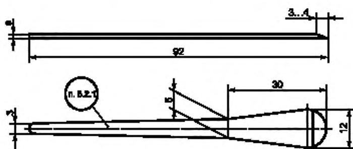
Рисунок А.2.9 — Лабораторный шпатель из платины или серебра
