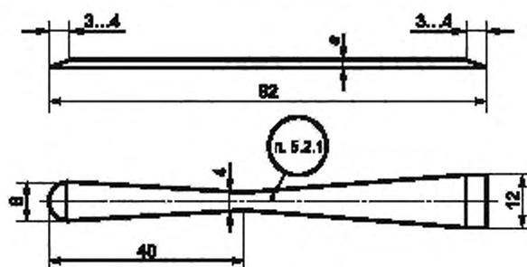
Рисунок А.2.7 — Лабораторный шпатель из платины или серебра
