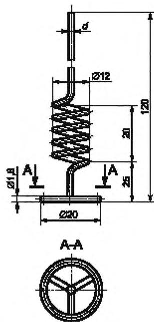
Рисунок А.3.7 — Проволочный электрод со спиралью из платины
