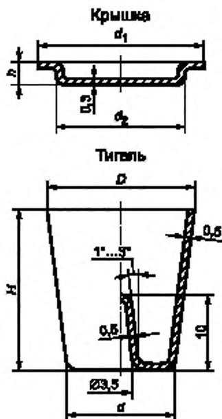
Рисунок А.2.27 — Тигель с крышкой для дериватографа из платины и сплава марки ПлРд 93-7 (Изделие № 222<sup>1)</sup>)
