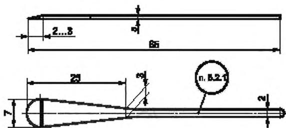
Рисунок А.2.18 — Лабораторный шпатель из платины или серебра
