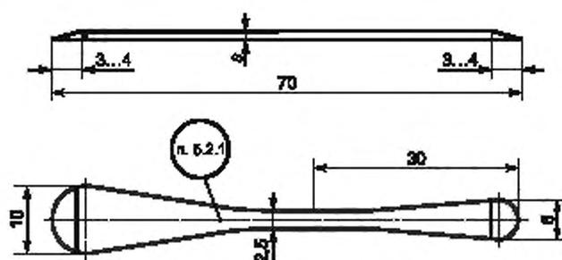
Рисунок А.2.15 — Лабораторный шпатель из платины или серебра
