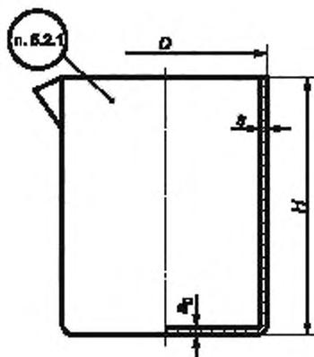
Рисунок А.1.21 — Цилиндрический стакан из платины или серебра
