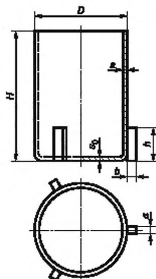
Рисунок А.2.22 — Тигель для вискозиметра из платины и сплавов марок
