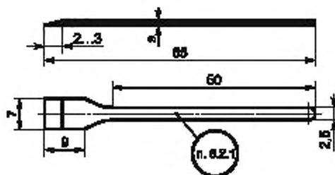
Рисунок А.2.19 — Лабораторный шпатель из платины или серебра
