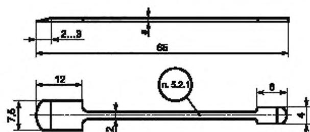
Рисунок А.2.16 — Лабораторный шпатель из платины или серебра
