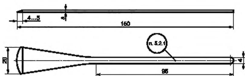
Рисунок А.2.20 — Лабораторный шпатель из платины или серебра
