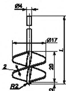
Рисунок А.2.26 — Мешалка с винтовыми лопастями из платины
