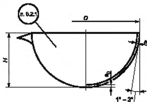
Рисунок А.1.15 — Чашка со сферическим дном из платины или серебра
