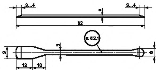
Рисунок А.2.8 — Лабораторный шпатель из платины или серебра
