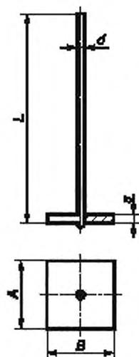
Рисунок А.3.13 — Пластинчатый электрод из платины
