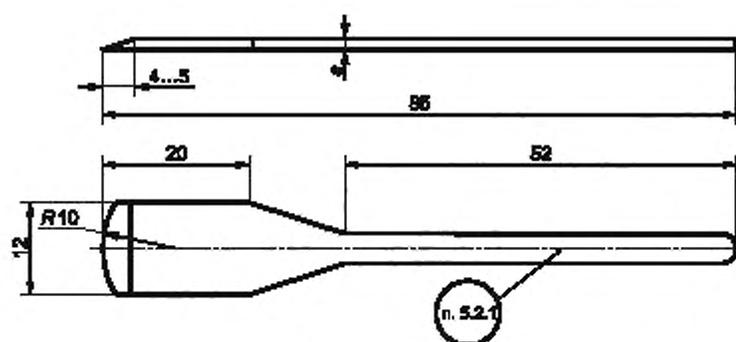
Рисунок А.2.12 — Лабораторный шпатель из платины или серебра
