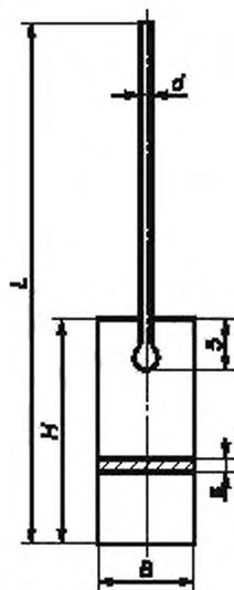
Рисунок А.3.12 — Пластинчатый электрод из платины
