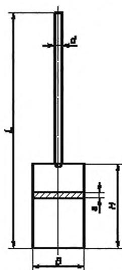
Рисунок А.3.11 — Пластинчатый электрод из платины
