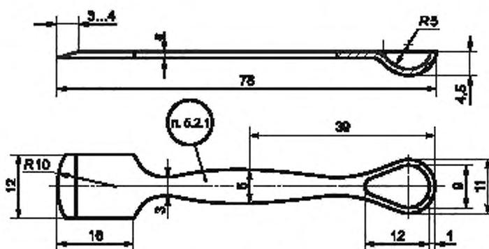
Рисунок А.2.10 — Лабораторный шпатель из платины или серебра
