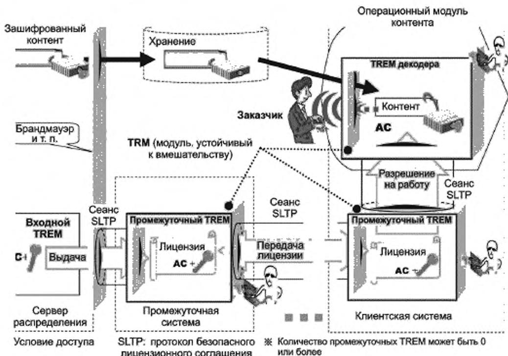
Рисунок 2 — Модель безопасности при защите контента
